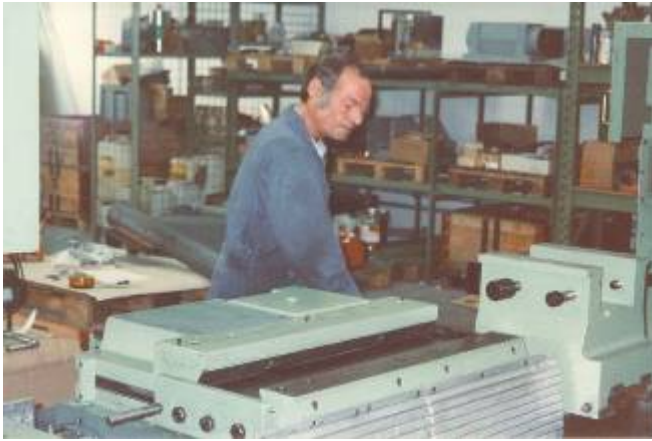
Bild 8: Wir haben das ganze Schlittensystem nach-gebessert. Schmierbohrungen ergänzt. Alles neu geschliffen und neu eingeschabt. Auf 10 Auflage-punkte pro mm/2 Zoll geachtet. WU4730
