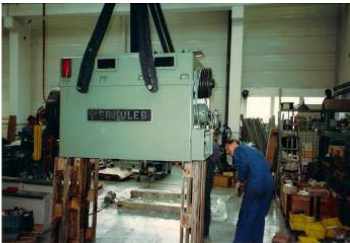
Bild 12: Nach dem Bettschleifen folgt das Ausrichten der Maschine. WU4720
