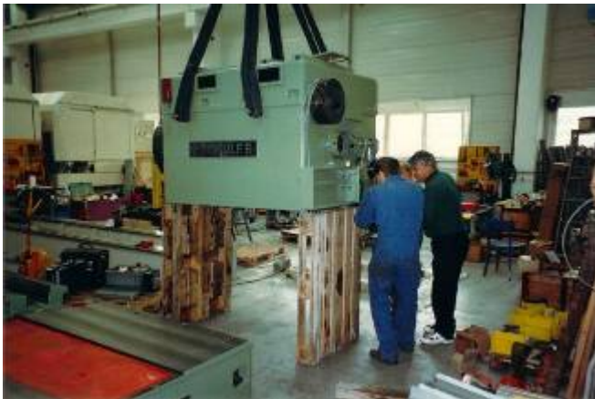
Bild 9: Auch der Spindelstock musste neu eingeschabt und ausgerichtet werden. Zylindrizität von weniger als 0.02 mm auf 500 mm. WU4710
