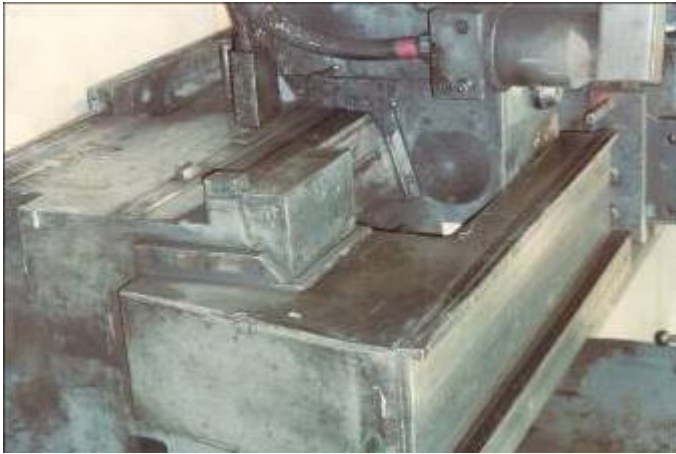
Bild 4: Die Unterschlitten Konstruktion musste für die Kugelrollspindeln in der X-Achse und Z-Achse umkonstruiert werden. 80 x 10 mm. WU4765
