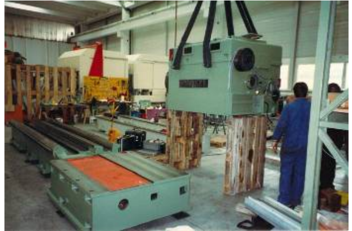
Bild 11: Diese robuste, schwere, konventionelle Walzendrehmaschine wird von der WIAP auf CNC umgebaut. WU4725
