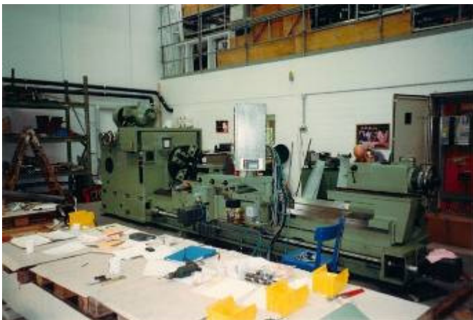
Bild 14: Diese schwere, robuste Walzendrehmaschine nach dem Umbau, bereit für die Rücklieferung ins deutsche Stahlwerk. WU4775
