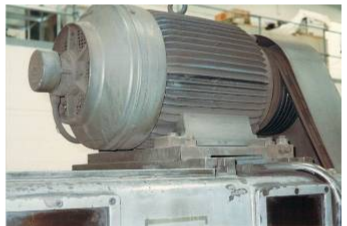
Bild 3: Starke Spindeltriebsmotoren. Die harte Walzenbearbeitung braucht ein gutes Drehmoment. WU4760
