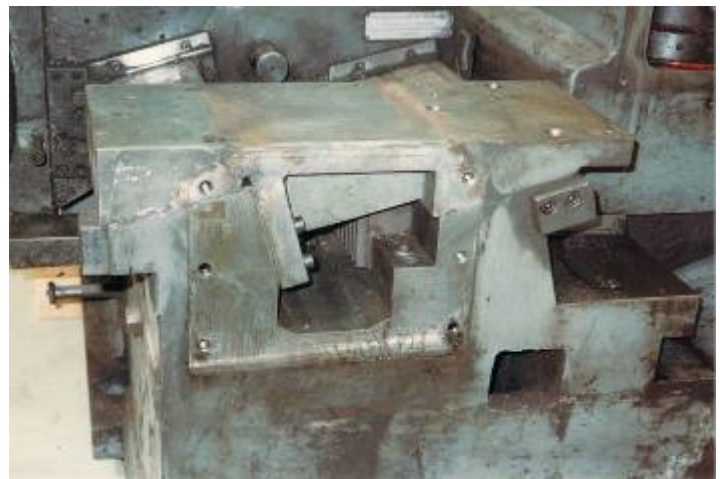
Bild 7: Guter, schwerer Guss, damit diese Maschine nicht in eine Eigenresonanz zu kommt. WU4755
