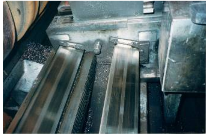
Bild 6: Die Z-Achsführung ist für einen sehr starken Querschnittsdruck ausgelegt. Die Maschine hatte 4 Stähle, welche gleichzeitig die Walzenkontur drehte. Dies ergab eine sehr grosse Führungsbelastung. Die Maschine hatte Einlagebänder aus Federstahl, welche wir austauschten. WU4740
