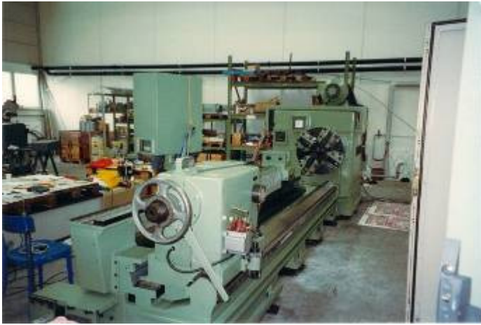
Bild 13: Wir haben mehrere solche Walzendrehmaschinen gemacht. Die CNC Programmierung war eine Erfindung der WIAP. Alles parametrisiert. Mit wenigen Parametern konnten diese älteren Operateure, welche vorher nur mit den Drehmaschinen kopierten und keine CNC Erfahrung hatten, innert Minuten ein neues Werkstück umrichten. WU4735
