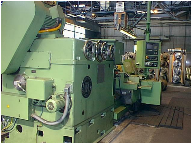
Bild 9: Ausserordentlich robust und stabil ist der Spindelstock. Der neue Spindel motor wurde wieder auf den Spindelstock gesetzt und elektrisch zur stufenlosen Drehzahl Regulierung ausgelegt.
