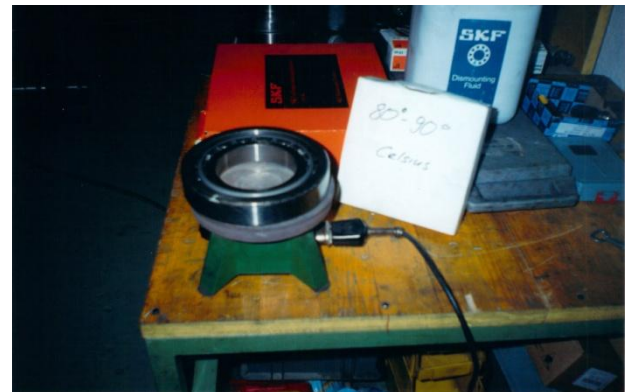
Bild 9: Spindellager wieder aufzuziehen geht gut mit Wärme. Eine Kochplatte kann viel erleichtern. Wichtig ist, sehr sauber zu arbeiten, damit kein Schmutz in die Lager gelangen kann. Hinten ist auch noch der Ölbehälter für die Pressverband Abpressvorrichtung.
