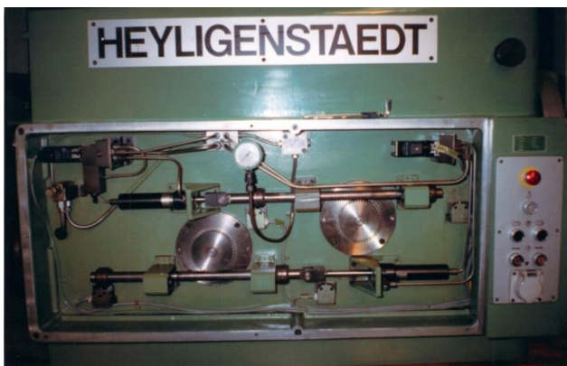
Bild 1: Das Schaltgestänge der Schaltgabeln wird über Zylinder angesteuert. Eine gut durchdachte, kluge Schallösung.
