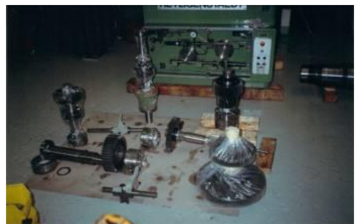
Bild 14: Ein immer gutes Reinigen und Abdecken vor dem Wiedereinbau ist auch wichtig, damit nicht eine Standverschmutzung die Lebensdauer beeinträchtigt.
