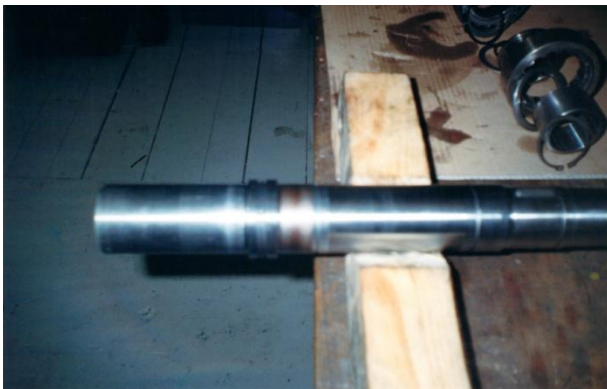
Bild 11: Auch die Getriebewelle wurde aus dem Spindelstock entfernt. In der Regel macht man alles ohne Hammer, sondern mit durchdachten Abzulösungen.
