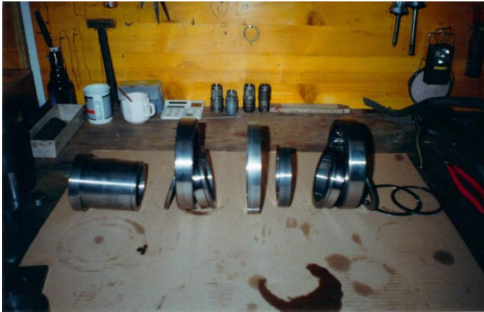
Bild 15: Ausgebaute Lager, die nicht ersetzt werden, müssen besonders vorsichtig behandelt werden. Darauf achten, dass die Käfige nicht beschädigt werden. Immer sehen, auf welcher Seite die grosse Öffnung ist, damit nicht aus Versehen am Aussenring Axial gepresst wird und das Lager auseinander fallen kann. In der Regel ist die Lagerbeschriftung immer auf der engen Seite.
