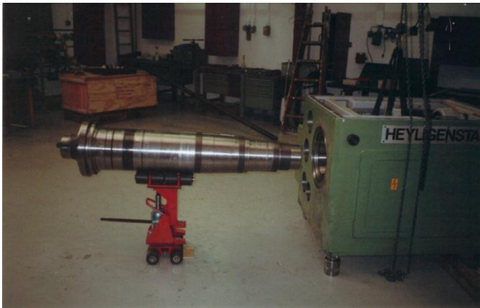
Bild 5: Hier haben wir die Spindel ausgebaut.
