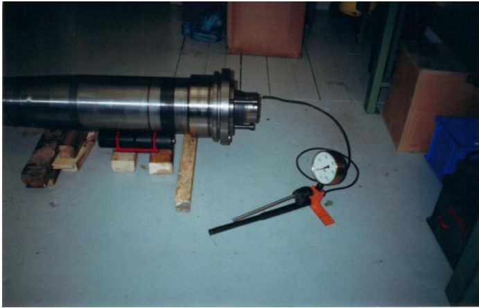
Bild 10: Hier wird mit der Pressverband Pumpe das Lager abgepresst. Das Verfahren war einige Jahre sehr populär. Wenn jedoch eine solche Pumpe fehlt, welche ca. 3000 CHF kostet und das Öl, dann kann die Demontage nicht erfolgen. Und wenn der Sitz ein wenig beschädigt wird bei der Montage und die Abdichtung nicht ok ist, dann ist eine Demontage sehr kompliziert und benötigt einige Fantasie, um ans Ziel zu kommen. Denn der Abpress Druck ist enorm beim Pressverband. Z.B. 2500 bar. In dem Fall war der Pressverband Ölanschluss vorne an der Spindel Nase.
