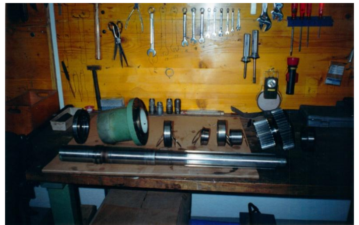
Bild 18: Auch die Getriebewelle, welche im Spindelstock eingebaut ist, sollte sauber und ohne Hammer demontiert und wieder montiert werden.
