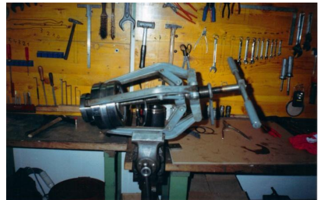
Bild 8: Es benötigt einige Abziehvorrüchtungen, um die Zahnräder und Lager abziehen.
