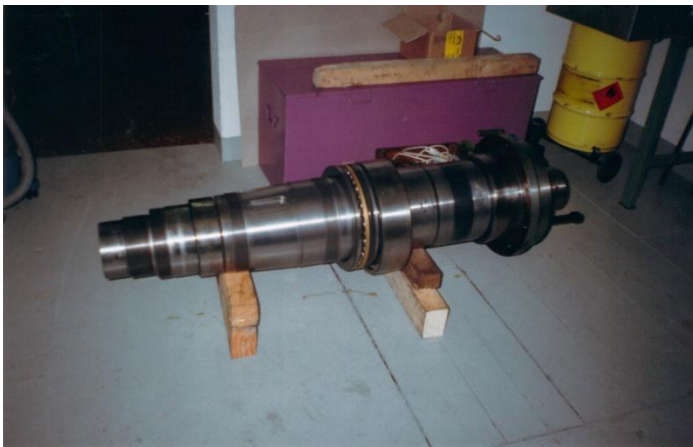
Bild 16: Diese Hauptspindel der Heyligenstaedt Drehmaschine hat schon Tausende Stunden ihren Dienst getan und kann es noch einmal viele Tausende Stunden machen.
