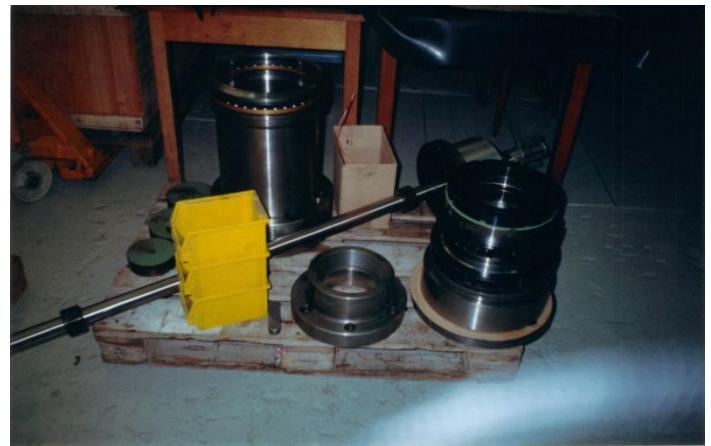
Bild 17: Bauteile vor dem Wiedereinbau der Heyligenstaedt Drehmaschine.
