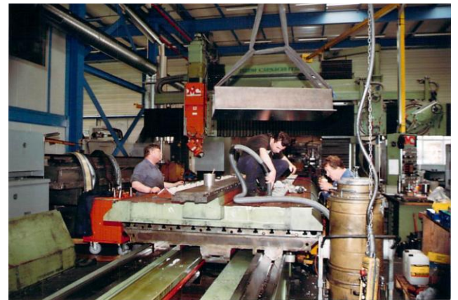
Bild 8: Eine grosse Maschine, mit einer klug ausgedachten Führungslösung. Beim Hobeln stört der Stick-Slip-Effekt nicht. Doch beim Fräsen mit einem langsamen Vorschub, ist es störend.
