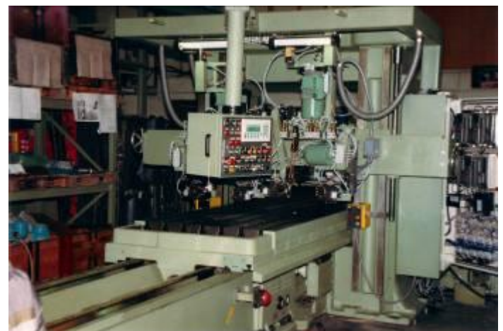
Bild 6: Als CNC Steuerung wurde eine von einem Deutschen Hersteller gewählt. Es wurden 3 Modi gewählt. Handbetrieb, Halbautomat und CNC Betrieb.
