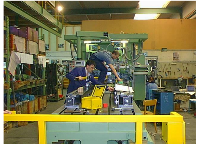
Bild 33: Anbau der Hornzone für diese Maschine. Es wird sofort gestoppt bei Gefahren Zonen Betretung.
