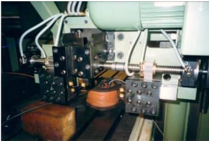
Bild 8: Dieses neue Schlittensystem wurde von der WIAP AG so konstruiert, dass gleichzeitig mehrere Stähle im Eingriff sein können.
