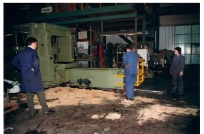
Bild 7: Der Tischantrieb läuft mit einem Hydraulik-antrieb, welcher bis 70 Meter in der Minute schnell sein kann. Da war es etwas ölig.
