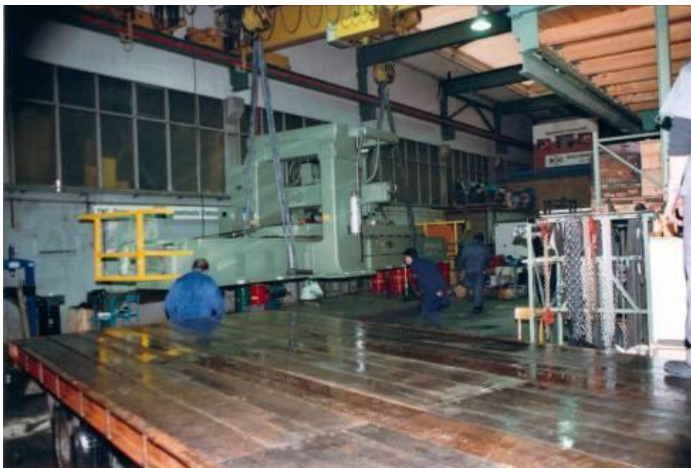
Bild 31: Die Maschine wird auf ein Tiefgänger Anhänger verladen.
