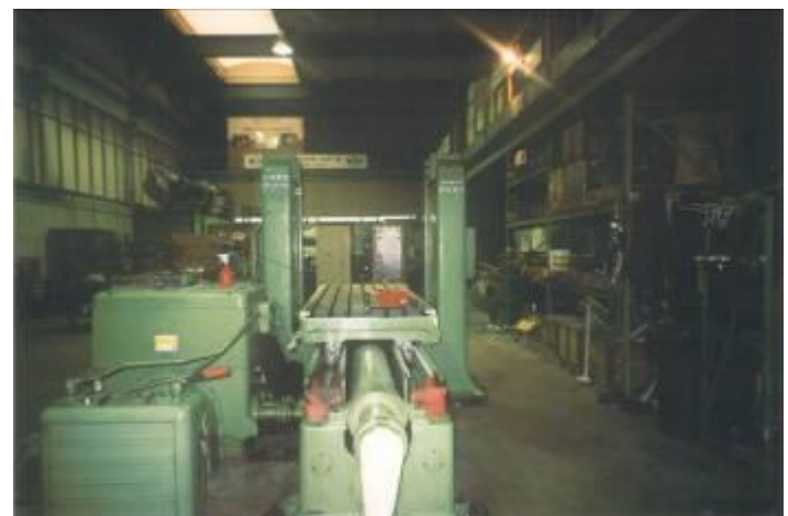
Bild 2: Dann auf einer grossen Lasersäge in der Mitte der Stiftlöcher durchtrennen lassen. Dann konnten die Stifte nur eingelegt und die Seitensäulen mit Seitenplatten befestigt werden.
