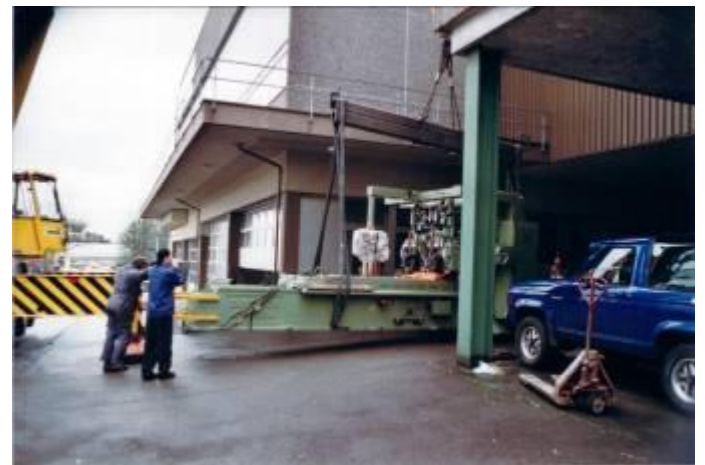
Bild 39: Beim Endkunden konnte die Maschine mit dem WIAP Transportjoch abgeladen werden.
