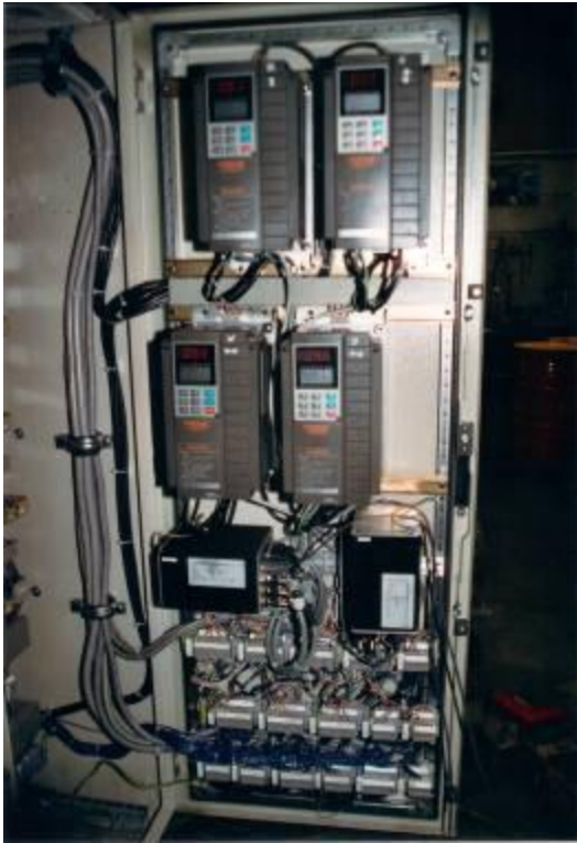
Bild 23: Bei der Lösung wurden normale Motoren, die lieferbar waren, als geregelte Vorschubmotoren mit einem geregelten System eingesetzt. Sie taten doch fast 20 Jahre ihre Dienste. Also ok.
