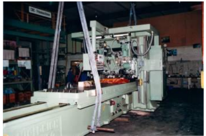
Bild 28: Die Löcher im Bett waren an der unteren Grenze für das Anheben der Maschine. Doch es musste gehen, weil der Ablad beim Kunden noch einiges komplizierter war.
