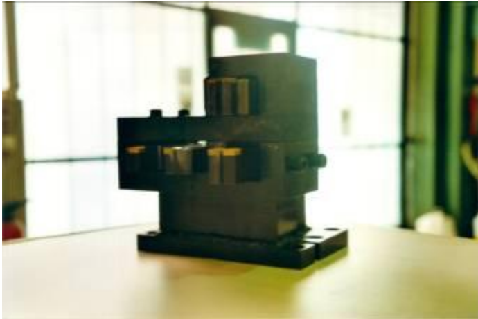
Bild 18: Robustes WIAP Stahlhalter Konzept für das Hobeln mit einer Waldrich Hobelmaschine.
