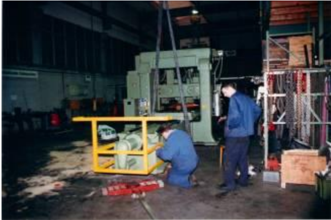
Bild 26: Diese schwere Wiap Waldrich Hobelmaschine wurde von der WIAP AG so konzipiert, dass sie als eine Transporteinheit geliefert werden konnte.
