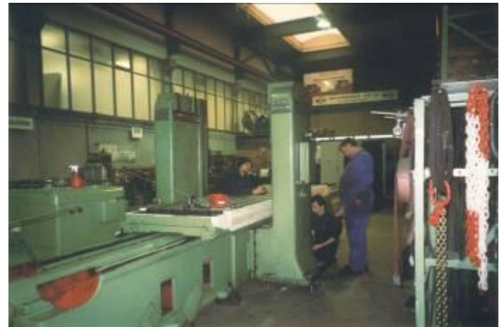
Bild 1: Die Hobelmaschine mit den verkürzten Seitensäulen. Zuerst haben wir 4 40 H7 Stiftlöcher auf einem Bohrwerk in 0.01 mm Genauigkeit bohren lassen.
