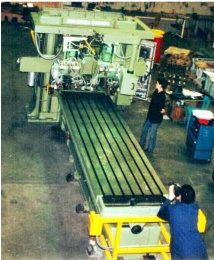
Bild 4: Das seitliche Zulaufen wurde mit Schutzzonen für den Operateur, mit einer sogenannten Hornzone und einer Stoppzone abgesichert.
