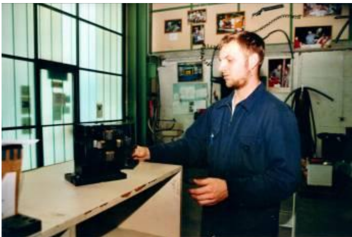
Bild 19: Die Werkzeugvoreinstellung und Kontrolle, ob die Herstellung gemäss der Zeichnung ok ist.
