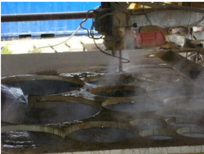
Bild 4: Die Maschine in der Produktion. Im 0,1 mm Bereich schneidet sie Rostfrei, Alu, Stahl usw. Wichtig, es müssen alle 6 Monate die Führungen oben gereinigt werden, damit nicht der Sand vom Abrasiv schneiden Rückbewegungen verursacht.
