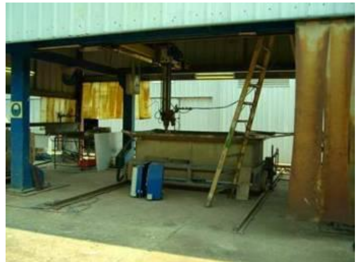
Bild 4: Die Maschine in der Produktion. Im 0,1 mm Bereich schneidet sie Rostfrei, Alu, Stahl usw. Wichtig, es müssen alle 6 Monate die Führungen oben gereinigt werden, damit nicht der Sand vom Abrasiv schneiden Rückbewegungen verursacht.
