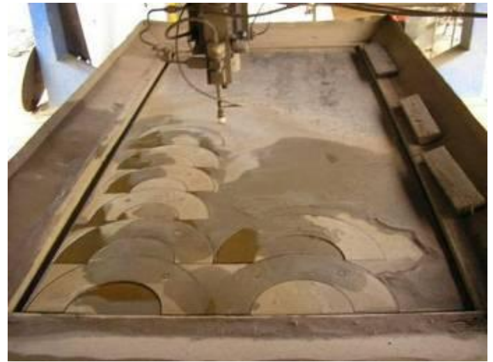
Bild 5: Hier der Arbeitsplatz der Wasserstrahlmaschine. Es können Platten 3 x 4 Meter bearbeitet werden. Vor allem braucht es diese Maschine für das rostfreie Material, weil man das mit der Brennschneid Anlage (Qxy Cut) nicht kann.
