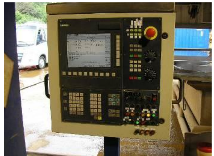
Bild 2: Die CNC Sinumerik 802. Ausgelegt mit Schutzlevels für diverse Leute, dass nicht der Lehrling gleich mit den Achsen fahren kann. Oder, dass der Operateur programmieren kann. Die Maschine hat 7 Schutzstufen.
