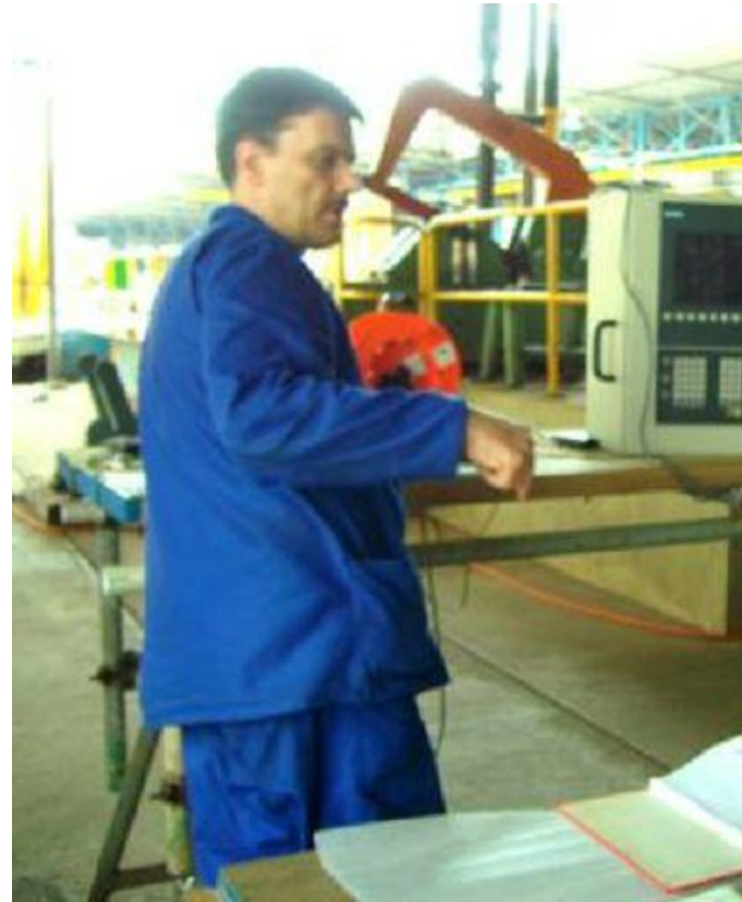
Bild 12: Juni 2016, Angola: 15 Jahre später. Wieder H.P. Widmer ein paar Jahre älter, wie die Maschinen. Die alten Sinumerik sind am Ende. Die Steuerungen werden vom Schwefel der Luft, sowie der hohen Luftfeuchtigkeit verfressen, welche oft bis 110% ist. Aber die Mechanik macht noch mit!
