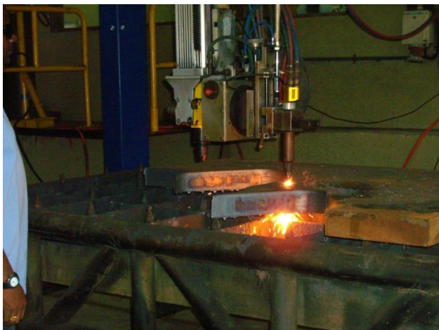
Bild 1: Bis 200 mm dicke Platten können mit der Anlage geschnitten werden.
