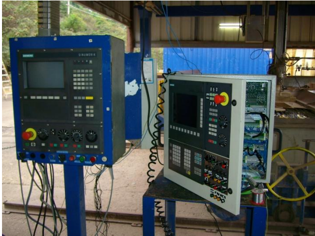
Bild 4: Hier wird die alte CNC gegen die neue ersetzt. Für die alte CNC gab es die Ersatzteil-Gewährleistung nicht mehr.
