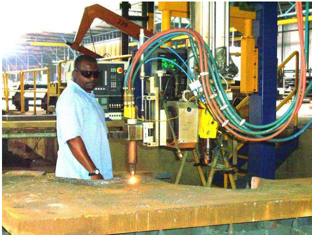
Bild 11: Operateur Melo beobachtet den Schneidprozess. Früher war ein Vorbohren Nötig, doch ein Sonderzyklus hat das Einstechen ohne Vorbohren, ermöglicht.
