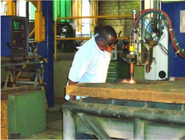
Bild 14: Jetzt macht die Maschine alles automatisch. Die Programmierung für das Vorheizen und mit den diversen Ventilen war schon noch ein paar Stunden Arbeit, denn der ganze Vorgang braucht ein wenig Erfahrung.
