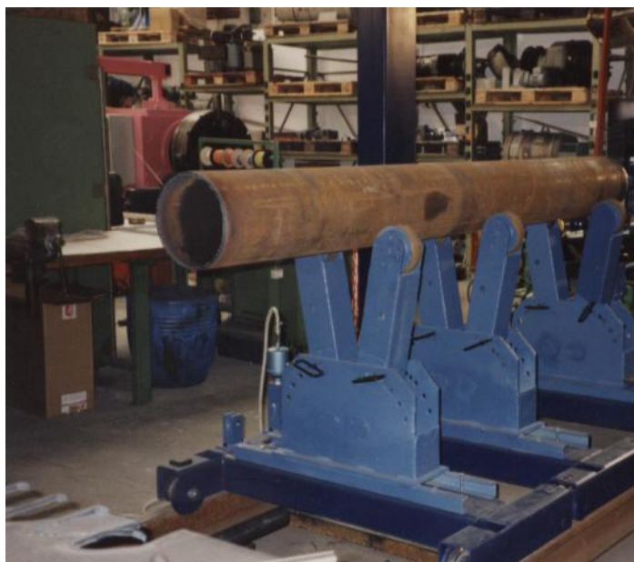
Bild 20: Hier die Rohraufgabe. Es war geplant, bis 12 Meter Rohre mit der Anlage Sättel zu schneiden.
