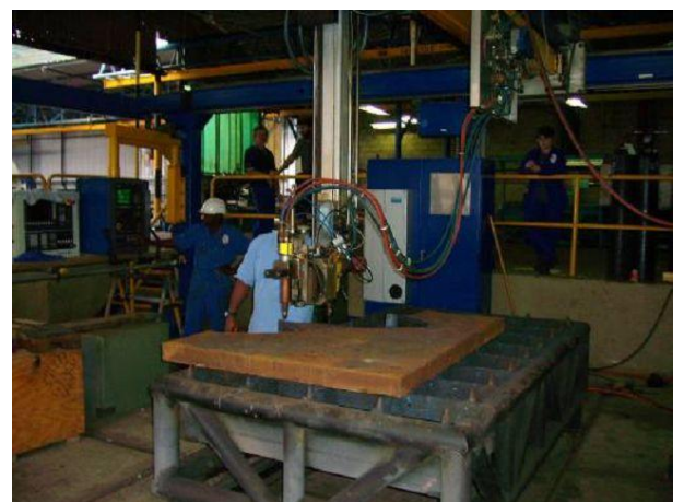
Bild 13: Hier wird ein Schnitt durch eine über 100 mm dicke Stahlplatte vorbereitet.
