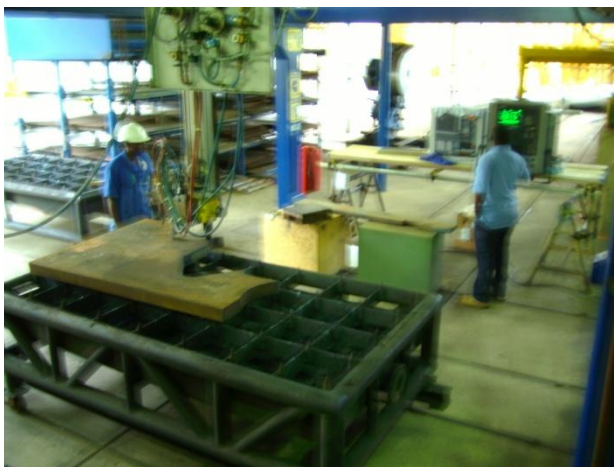
Bild 6: 3000 x 4000 und 2000 mm Hub / Senk / Bewegung. Hier kann gemacht werden, was gemacht werden muss. Die Brenn Schneid Maschine hat fast keine Grenzen.
