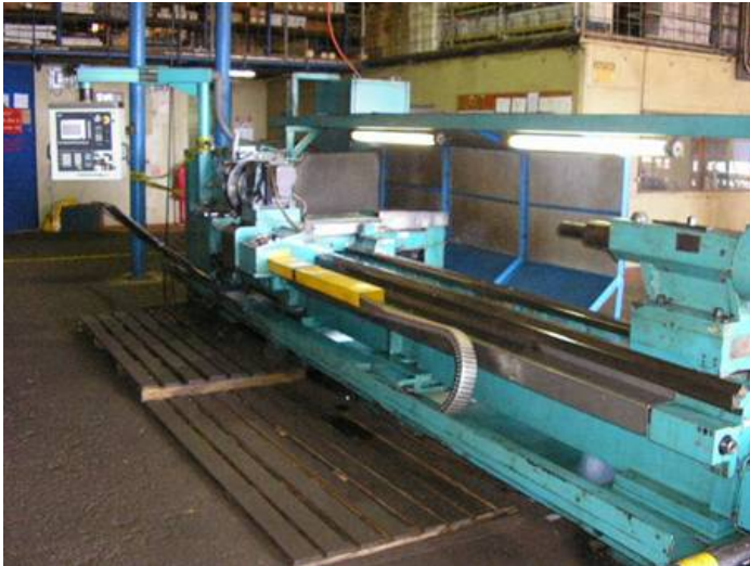
Bild 1: CNC Drehmaschine, welche in der Schweiz bei Grossfirma stand. Erste CNC war eine Sinumerik 5T. Diese wurde das erste Mal auf eine Sinumerik 810T und ein zweites Mal, 20 Jahre später, auf eine Sinumerik 802 umgerüstet.
