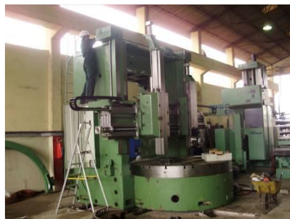
Bild 22: Vormalig eine konventionelle Karussell Drehmaschine und jetzt neu eine CNC gesteuerte Maschine.
