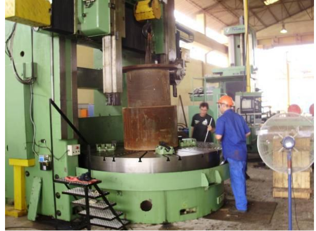
Bild 1: Vormalig konventionelle TITAN Karussell Drehmaschine aus Europa, in Angola umgebaut auf CNC Steuerung.
