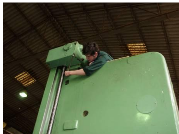
Bild 21: Sven Widmer beim Festziehen des Querbalken Antriebs, nachdem die Stifte gesetzt wurden, die wir aus der Schweiz bekamen, weil viele mittleren Schrauben nicht mehr vorhanden waren zur Maschine.
