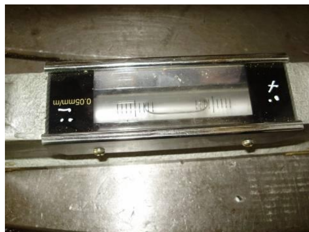
Bild 46: Auch wird geprüft mit der Rahmenwasserwaage, wie die Planscheibe steht. Wir nehmen, in der Regel, immer eine Wasserwaage mit der Genauigkeit von 0.05 mm pro Meter (0.02 ist besser, aber die ist auch sehr empfindlich. Reagiert sofort auf Sonnenlicht.)
