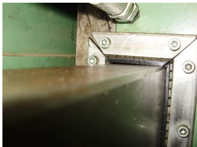
Bild 28: Bei der Nachinspektion solche Abstreifer gefunden. Diese drücken ungenügend auf die Führung und so kann Schmutz unter dem Abstreifer durch.
