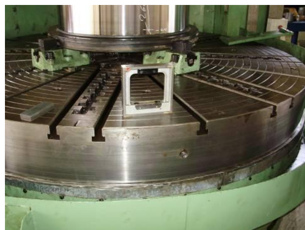
Bild 45: Vermessen mit der Rahmenwasserwaage auf der Planscheibe.
