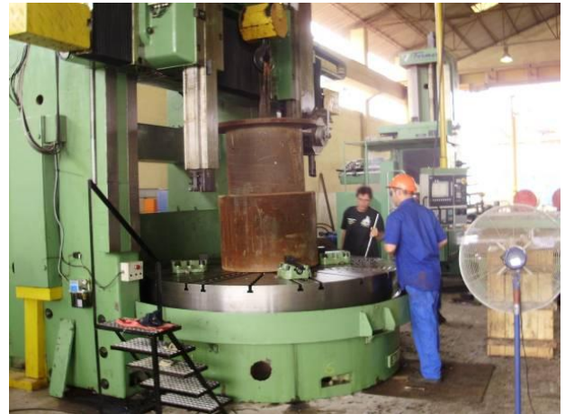
Bild 55: Gut rundrichten mit den 4 robusten Klauenkasten.
