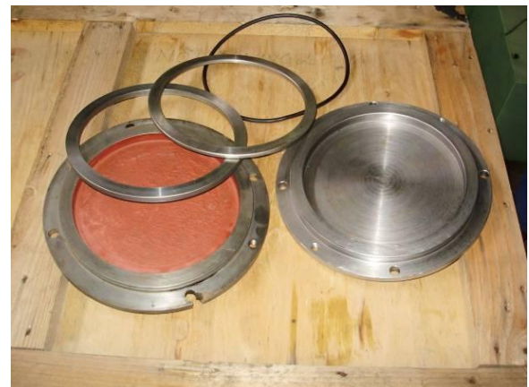
Bild 34: Der Graugussdeckel unten war defekt. Dann waren 2 Distanzscheiben montiert und diese waren 2 mm zu dick, d.h. es presste mit voller Kraft gegen das Kegelrad. Wir machten einen neuen Deckel und einen Distanzring 2 mm dünner, damit es nur wenig Spiel hatte. Der O Ring im Deckel war auch nicht montiert. Also erklärbar, dass das Öl rauslief.
