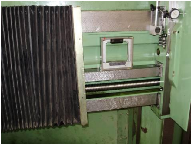
Bild 47: Der Querbalken wird auch geprüft. Wenn der nicht gut ist, kann er eingestellt werden oben an der Welle. Aber da müsste man zuerst eine Plandrehung machen.
