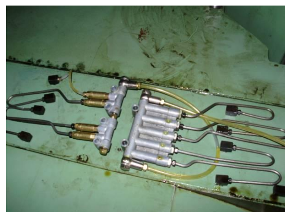
Bild 40: Neue und alte Schmier Komponenten gemischt.
