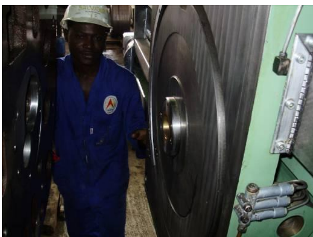
Bild 19: Hier das Einfädeln. Mit den langen Schrauben drauf, das ging nur, wenn wir zuerst ohne Schrauben, genau die Mitte mit dem Kran, anpeilten .
