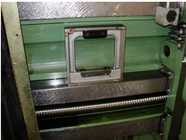
Bild 48: Wenn es möglich ist, eine gute Referenzfläche nehmen, um mit der Wasserwaage die Gradheit zu prüfen.
