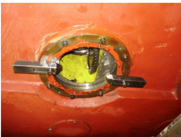
Bild 31: Wie unter der Maschine eine Seitenwelle rein kam, die die Drehzahl über das Kegelrad im Bild misst.
