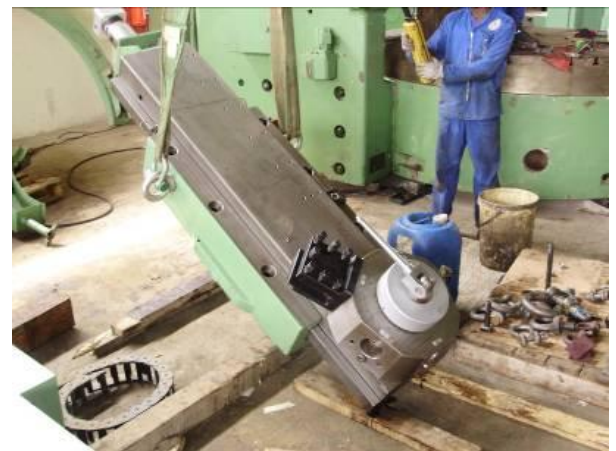
Bild 17: Die Schlittenmontage. Trotz Sonntag, wo um 16.00h die Arbeit beendet wird. Hier sind 7 Tage / Woche, gefordert.
