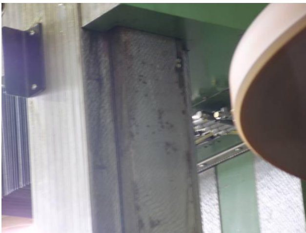
Bild 53: Der Stößel stand lange. Unter den Führungen Rost. Dieser hat dann schon mitgewirkt, da hatte es auch kein Öl !
