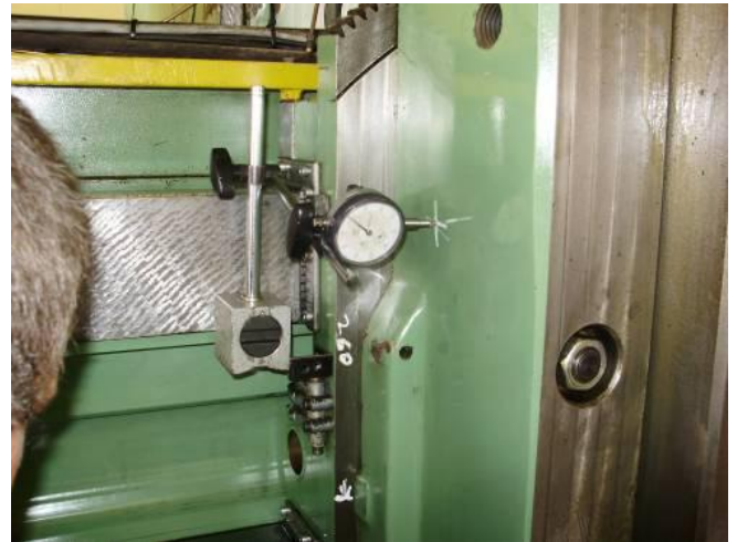
Bild 50: Das RAM hat einen Schwenkpunkt und vom Mittelpunkt genau 260 mm so lange, wie die Drehfläche ist, die Uhr anstellen. Immer berücksichtigen, dass wir im Radius drehen und Durchmesser messen, d.h. der Fehler ist auf 260 mm nicht 0.15 mm, d.h. nachstellen nur 0.075 mm. Und wird nachgestellt. Das RAM hat für diese Nachstellung oben eine Drehschraube.
