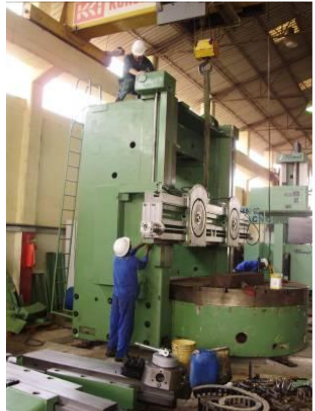
Bild 16: Der Querbalken ist jetzt oben. Er muss noch eingestellt werden mit der Wasserwaage.
