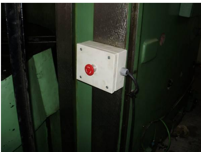
Bild 37: Noch Notstopptasten angebracht, damit, wenn ein Mann in der Maschine ist, er noch den Notstopp drücken kann.
