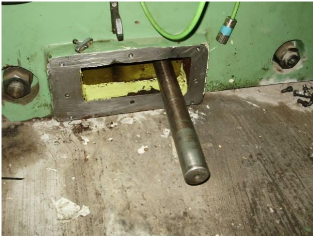
Bild 35: Diese Welle war noch ca. 4 mm zu lang. Also kürzen wir die Welle um wenige mm, damit der Deckel auch richtig abgedichtet hat.
