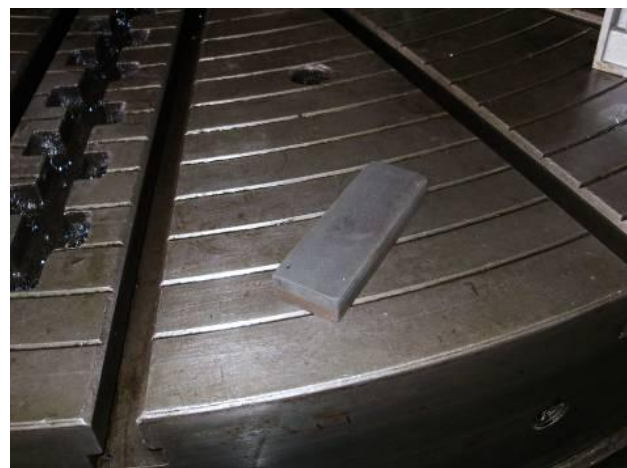
Bild 44: Mit dem Oel Abziehstein wird der Tisch abgezogen. Wichtig, immer mit grosser Sorgfalt mit dem Tisch und Führungen umgehen.
