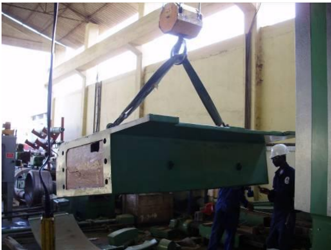
Bild 9: Das Dach und die Querverbindung mit der Zwischenplatte, damit ein gutes Einfahren ein Verkanten ausschliesst. Auch das Dach ist mit 18 Stk. M36 Schrauben verbunden.
