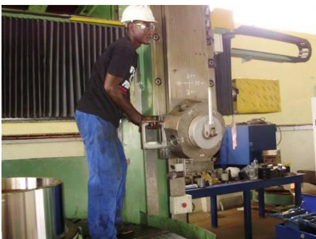
Bild 49: Überprüfung, ob das RAM im Wasser steht.
