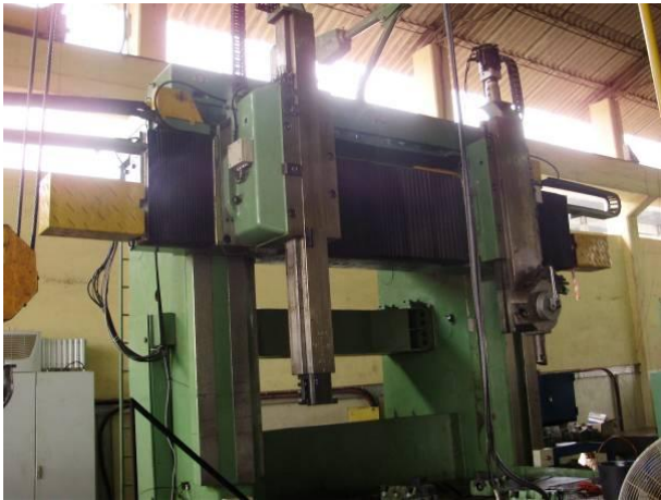
Bild 52: Jetzt wird maximal nach unten dann maximal nach oben mit dem Querbalken gefahren, um auch die Endlagen Schalter zu kontrollieren .
