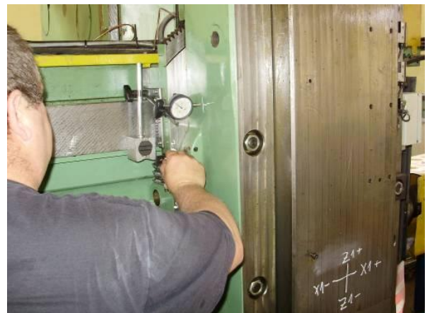
Bild 51: Nach dem Einstellen werden die 4 Schrauben vorne am RAM wieder festgezogen.
