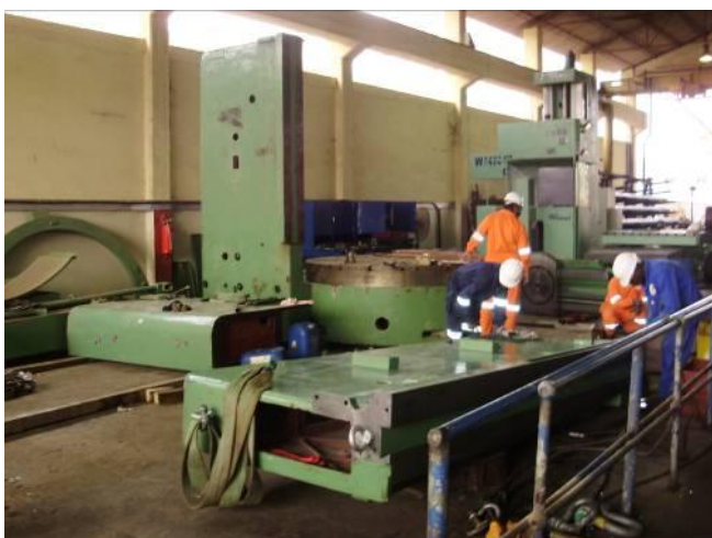
Bild 4: Auch die Führungen werden abgezogen vor der Montage, damit keine Beschädigung durch Verletzungen der Flächen, erfolgen können.
