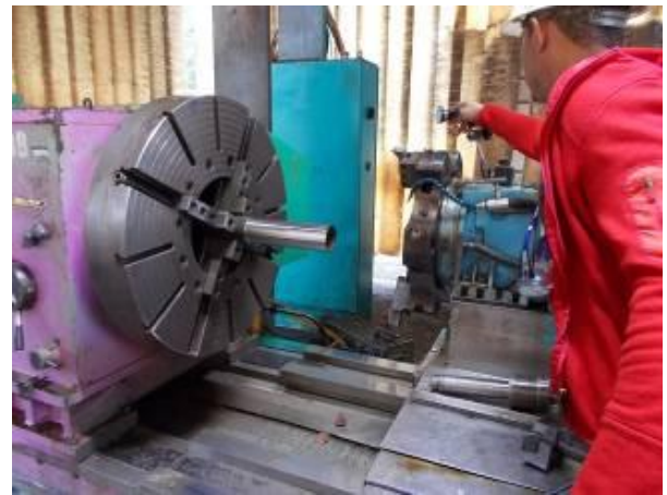
Bild 15: Die Konizität des Werkstückes des Spindelstockes wird ermittelt . 7 Seiten Protokoll für VAM. 14 Seiten hat das interne Protokoll.
