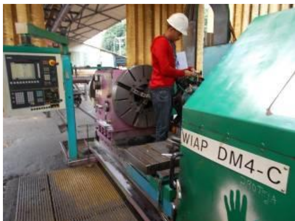
Bild 17: Immer Ende Juni werden an allen CNC Drehmaschinen die Unterlagen ausgetauscht. Der Geometrietest erneuert, der jedes Jahr gemacht werden muss.
