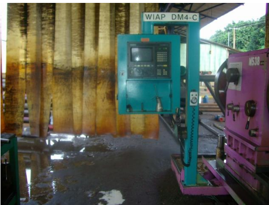
Bild 1: Der zweite Umbau der Maschine. Anbau Umbau 1 auf Sinumerik 810. Umbau 2: Sinumerik 802
