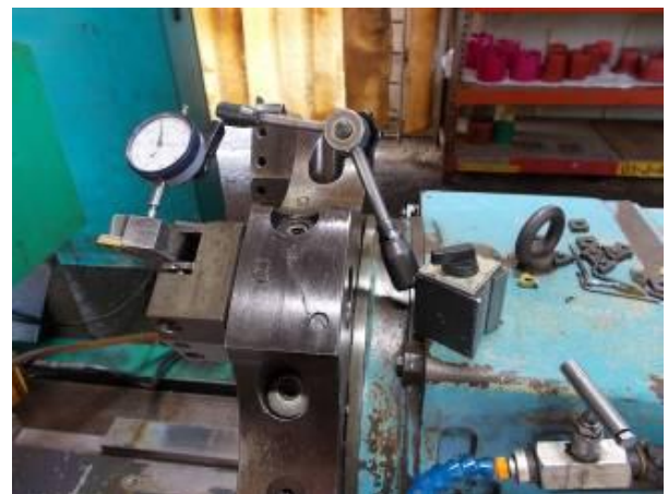
P16: Der Revolver muss ohne Spiel sein, sonst vibriert es beim Drehen. Das heisst, die Qualitätsanforderungen werden nicht erreicht.
