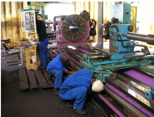
Bild 12: Hier wird der Z Schlitten abgehoben
