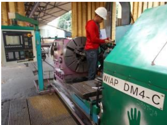
Bild 2: Hier die wieder erneuerte Maschine mit der Sinumerik 802. Wie viel Arbeit dahintersteckt, ist kaum erkennbar siehe hinten.
