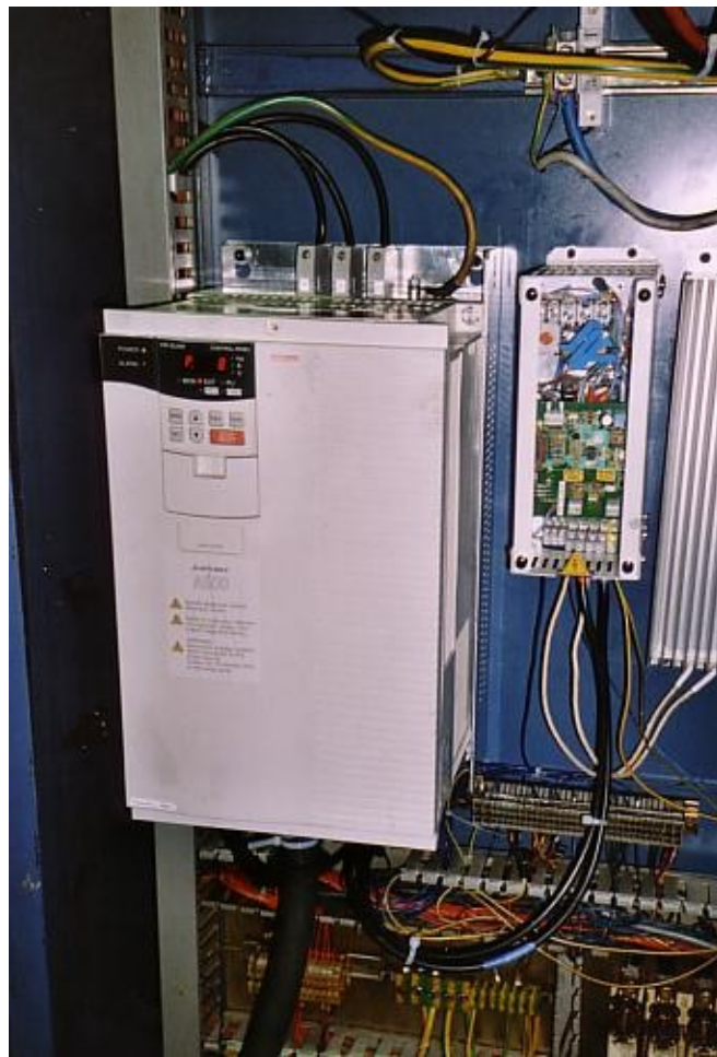
Bild 8: Neuer Spindeltrieb für die Graziano CNC Drehmaschine.
