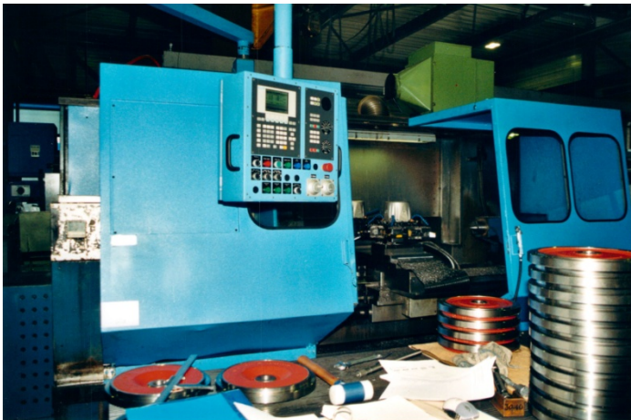
Bild 1: Graziano SAG Drehmaschine mit neuer CNC Steuerung
