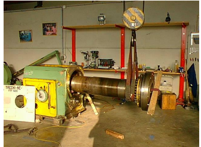
Bild 8: Jeder Maschinenhersteller hat seine eigene Art Spindellager zu machen. Wenn die Wärme auf eine zu grosse Axiallager Distanz drückt, sind bestimmte Lagerarten nicht die Besten. Tacchi hat unserer Meinung nach, nicht die beste Spindellager Lösung bei der Maschine gewählt.
