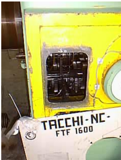
Bild 6: Reparatur Spindelstock Tacchi
