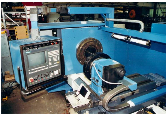
Bild 1: Die Tacchi CNC Drehmaschine bekommt eine Steuerung neuerer Generation.
