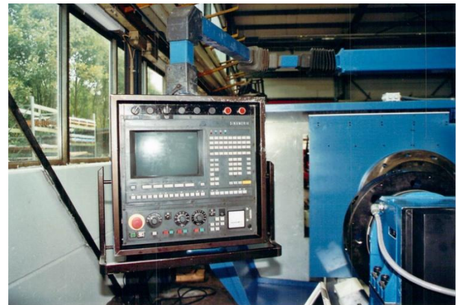
Bild 2: Anbau der neuen CNC mit Inbetriebnahme und Schulung
