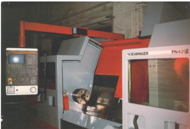
Bild 1: Böhrlinger PN 420 umgebaut mit einer neuen Sinumerik CNC Steuerung
