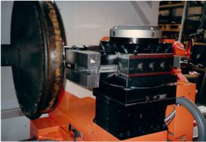
Spurkränze drehen ist ein besonders Thema. Doch die CNC-Technik kennt da keine Grenzen. Im Gegensatz zum früheren Kopierdrehen, sicher viel einfacher. WU5287b
