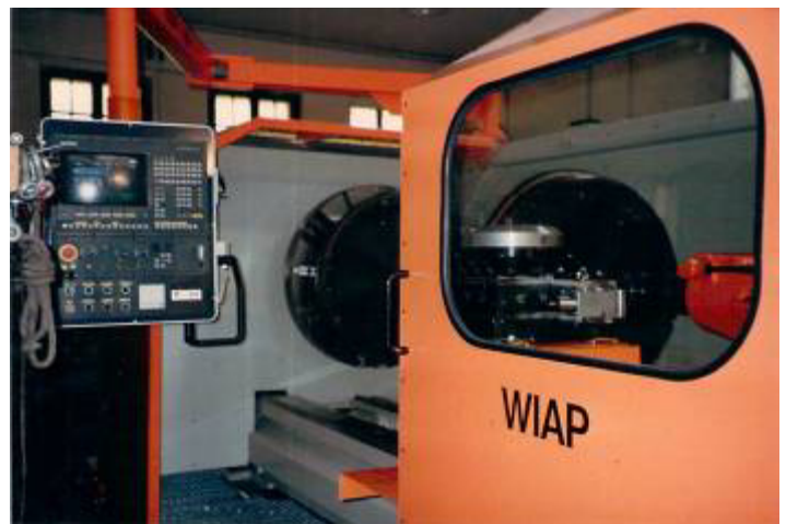
Und so sieht sie aus, komplett auf eine CNC-Maschine umgebaut. WU5293
