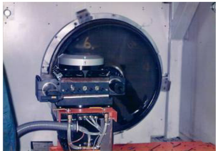
Das Spezial Futter, welches für diese Anwendung hergestellt wurde, mit dem 4 Fach Revolver. WU5295
