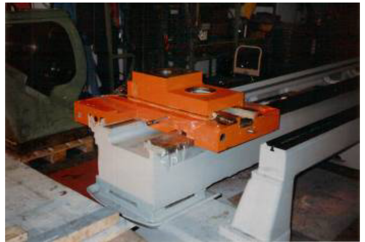
Nach dem Ausrichten des Maschinenbettes wird der Kreuzschlitten neu eingeschabt. WU5237
