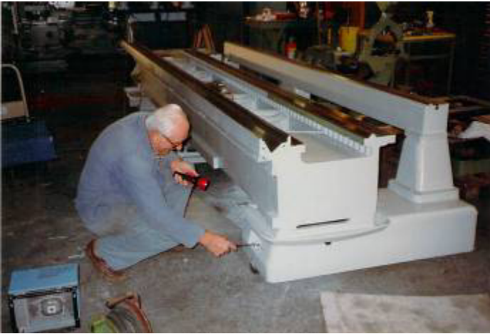
Das ganze Bett wird nach dem Schleifen neu ausgerichtet. WU5250
