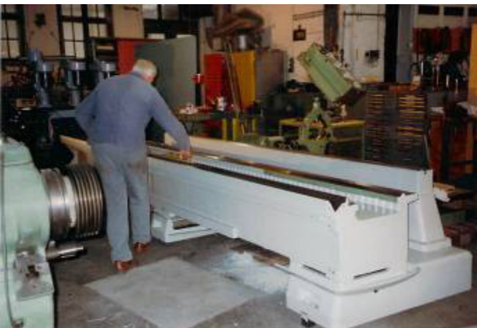
Diese robuste, konventionelle Drehmaschine wird jetzt eine CNC-Maschine. WU5246
