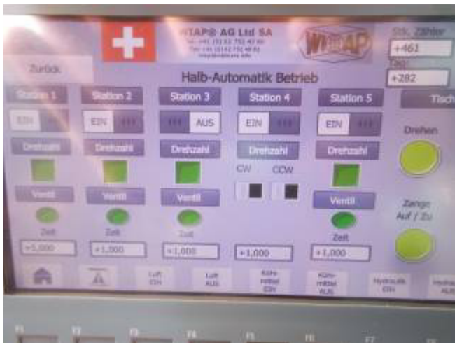
3 Grundbilder der Maschine: Hand, Halbautomat und Automat, einfach für den Operator, für eine sichere Handhabung. WU5130u
