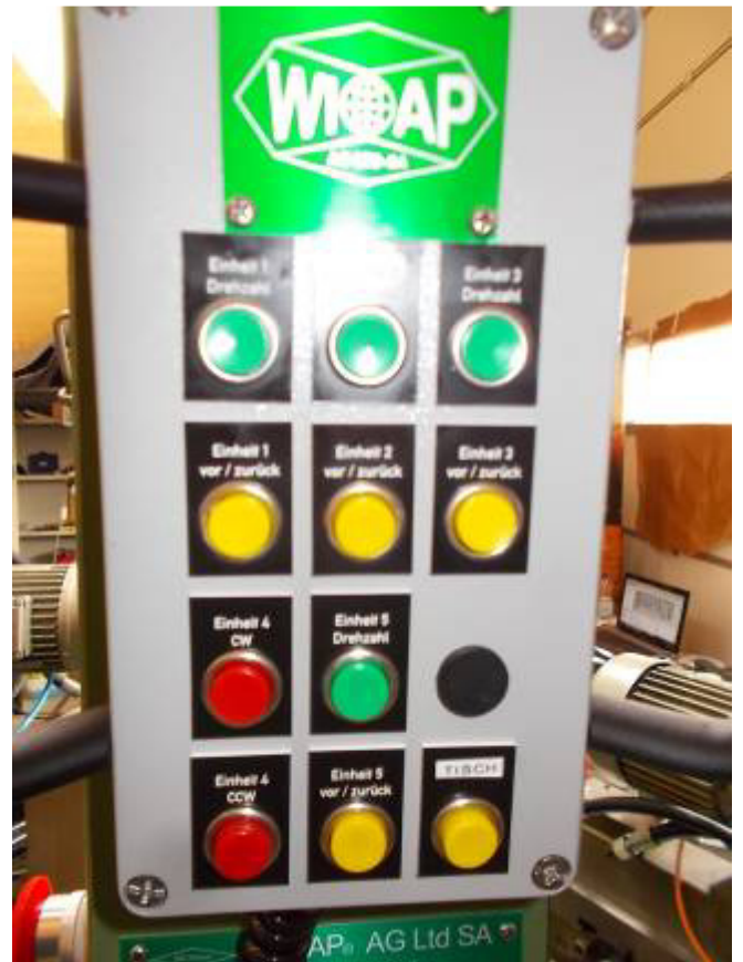
Externes Bedienpanel mit vorstehenden Griffen, damit es beim Runterfallen nicht die Tasten beschädigen kann. WU5130v
