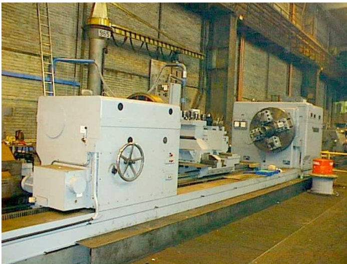
Bild1: Nach dem Umbau der WDK 850 MFD Walzendrehmaschine, durch die WIAP AG.
