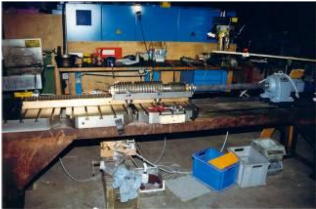
Bild 20: 2 Tage musste gehont werden, bis die Spindel wieder dasselbe Mass hatte zwischen der mittleren Zone und der Aussenzone, so dass die Spindel spielarm eingestellt werden konnten. Das Spiel war praktisch weg.
