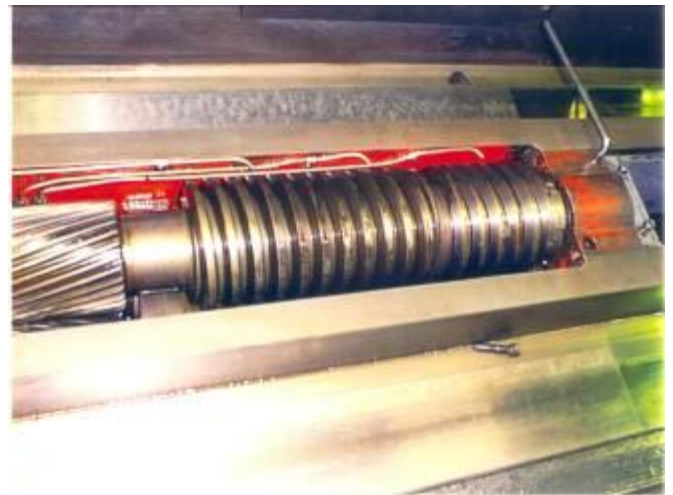
Bild 23: Diese Längsschlitten Schneckenwelle war im mm Bereich ausgelaufen. Nach der Revision wieder im 0.1 mm Bereich spielarm.
