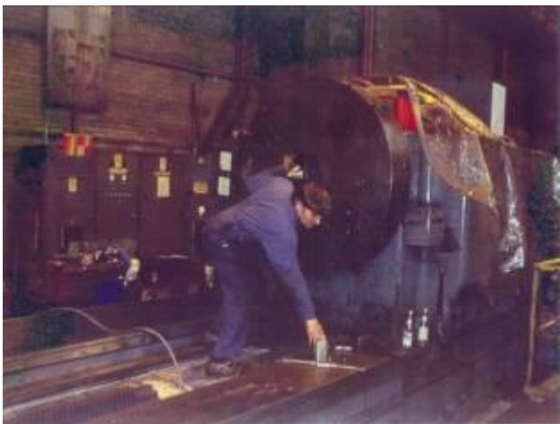
Bild 8: Die Demontage des Z-Schlittens, welcher zu uns in die Schweiz zur Revision ging.
