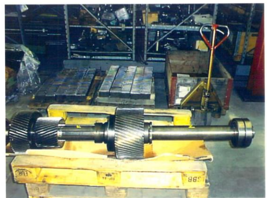
Bild 23a Welle aus dem Vorschub Getriebe
