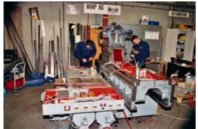
Bild 17: Die Schlittenführung wurde mit SKC neu belegt. Die ganze Schmierung verbessert und erneuert. Die komplette Schlittenrevision in der Schweiz dauerte 6 Wochen.
