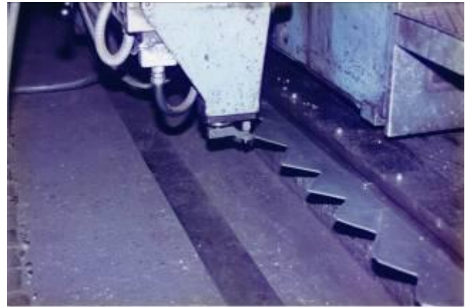
Bild 9: Die Maschine ist mit einer Kopiervorrichtung ausgerüstet. Die Kopiertaster sind von der Firma Heid. Die Elektronik des Kopiertasters von Siemens. Diese Elektronik war nicht mehr erhältlich. Die WIAP AG hat 4 neue WIAP Kopierkarten herstellen lassen, nach dem Muster Siemens. Mit neuen Bauteilen, weil die alten nicht mehr zu kaufen waren.
