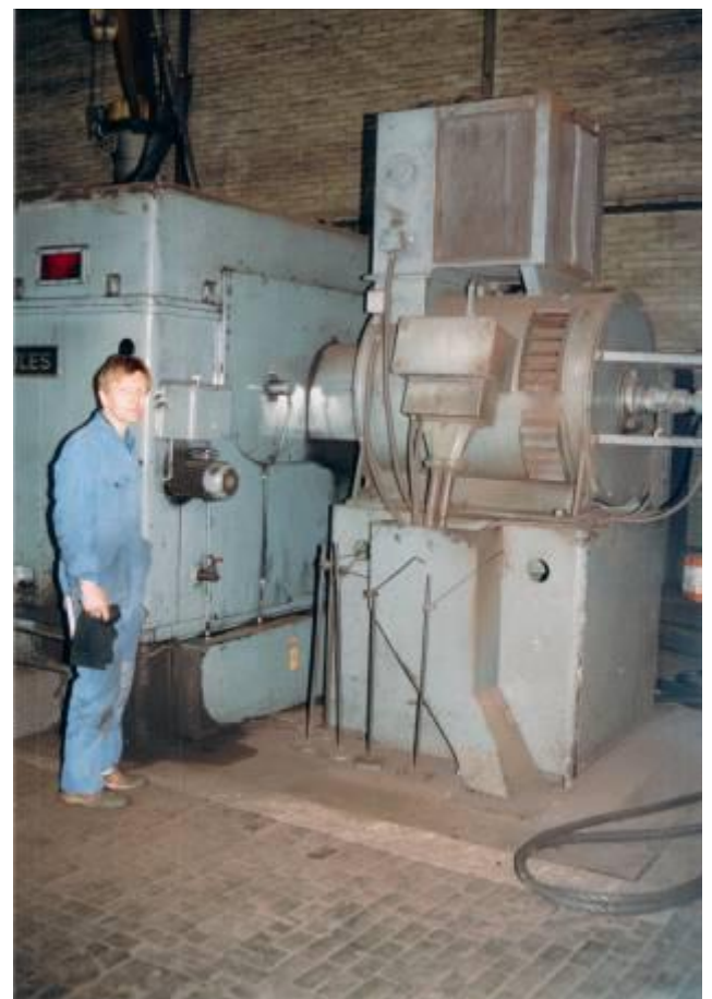
Bild 6: Der Spindelstock ist fast so gross wie ein Kinderzimmer. Der 220 KW Motor sehr kräftig.
