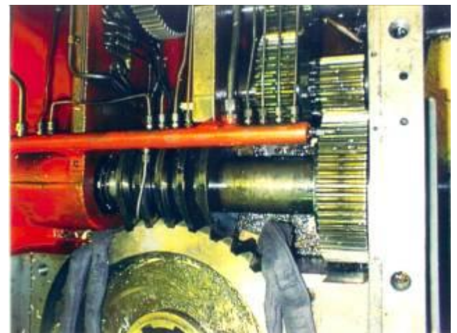
Bild 18: Der ganze Längsschlitten Vorschubantrieb, welche die Zahnstange antrieb, war komplett ausgelaufen.
