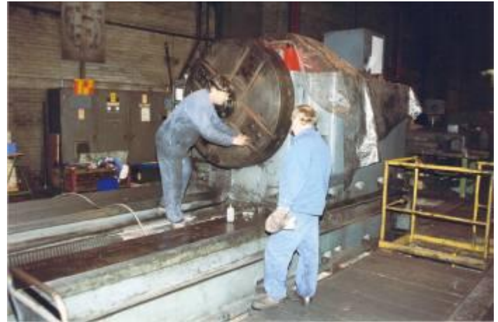
Bild 1a: Vor dem Umbau der 150 Tonnen Maschine Waldrich WDK 850 Maschine MFD. Vorher: Die Maschine konnte nur teilweise in die Schweiz geliefert werden, für die Revision. Die Zerlegung der 150 Tonnen Maschine war teurer, als vor Ort zu revidieren.
