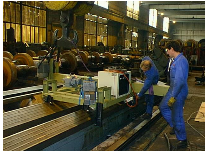
Bild 12a: Wie mit einer transportierbaren Fräsvorrichtung wird hier bearbeitet. Als Referenz wird die vordere, nicht abgenützte Schlittenführung genommen. Es wurde die stark abgenützte Reitstockführung nachgefräst, welche mehrere mm aus der Mitte ging. Die Maschine mit 150 Tonnen zerlegen und extern bearbeitet lassen, wäre aufwendiger und teurer gewesen.
