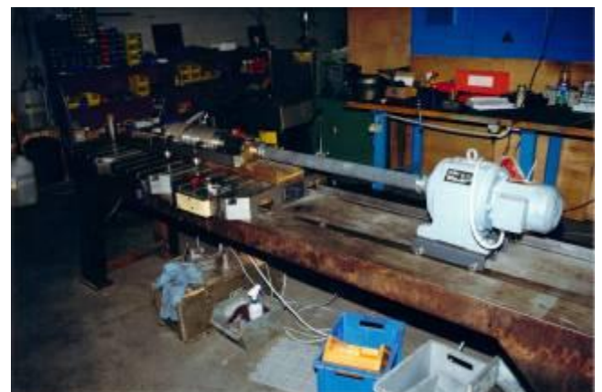
Bild 19: Die ausgelaufene Spindel wurde mit einer WIAP Hohnvorrichtung gehont.
