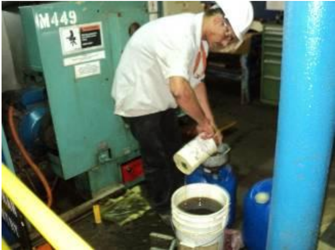
Bild 5: Auch das Öl wird ersetzt. Der Tank wird innen auch gereinigt, wenn Abrieb drin ist soll die Ursache gesucht werden.
