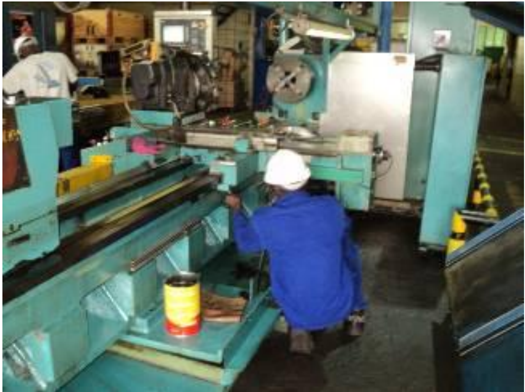
Bild 4: Es wird alles vorbereitet, um den Schlitten abzuheben. Untergriffe weg. Kugelrollspindel weg usw.
