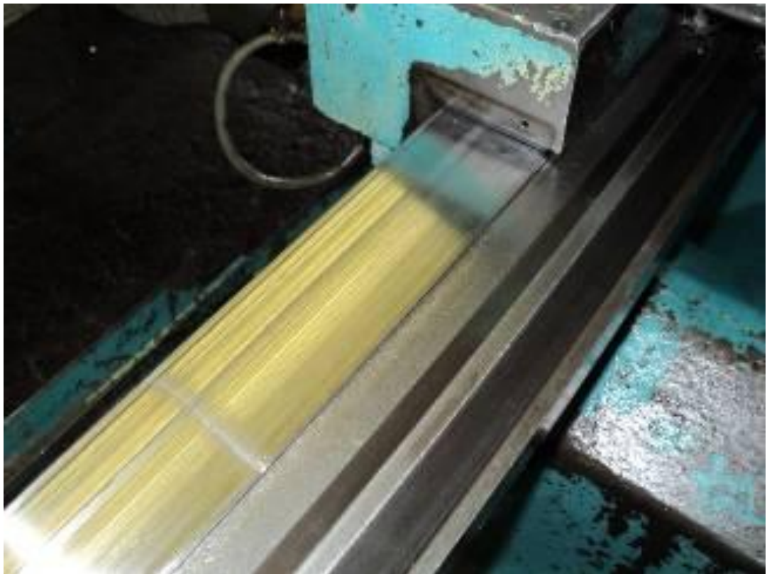
Bild 2: Die hintere Z Führung hat seit einiger Zeit immer tiefere Spuren. Es wurde geplant, den Z Schlitten abzuheben und die Ursache zu prüfen und eine Nachbesserung durchzuführen
