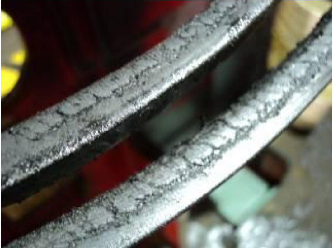
Bild 8: Diese Keilriemen sollen auch ersetzt werden.
