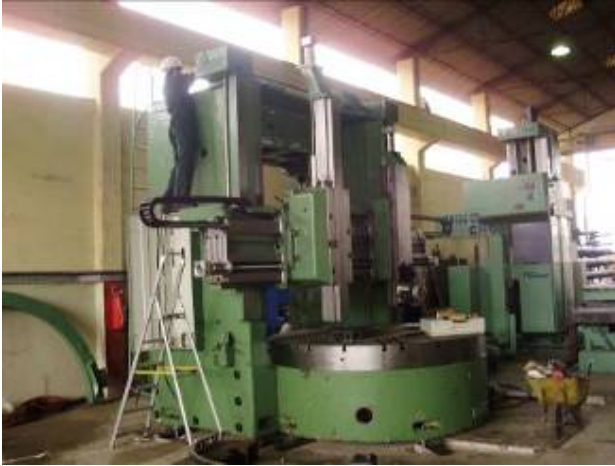
Vormals eine konventionelle Karussell Drehmaschine und jetzt neu eine CNC gesteuerte Maschine. WU_240_210
