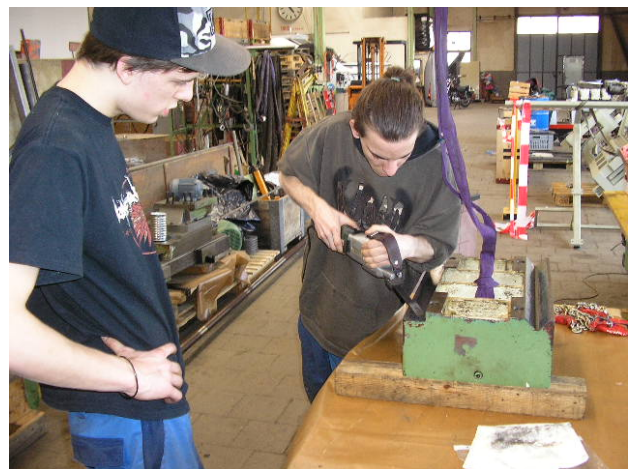
Schaben der Geometrie, pro mal ca. 0,004 mm
