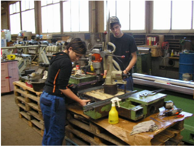
Photo: Caro bohrt neue Schmierbohrungen in den Schlitten.
