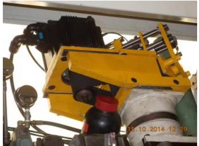
Damit alle Vorschubmotoren ohne Bremsen verwendet werden konnten, wurde aus Ersatzteil Gründen eine externe X Bremse hergestellt, nicht im Motor.
