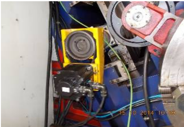
Der ganze Z Antrieb wurde mit einer Unter- setzung 1:2 Konstruktion Wiap erneuert.
