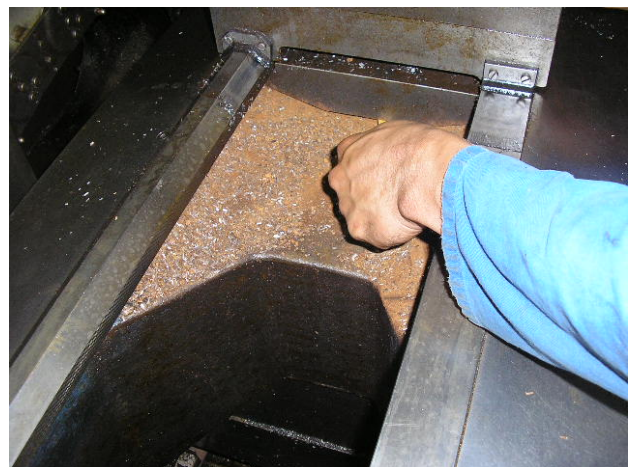
Photo: Dan findet man den Rost unter allen Abdeckungen, fast wie in Angola! Also entscheidet man viele Bleche abzuschrauben.
