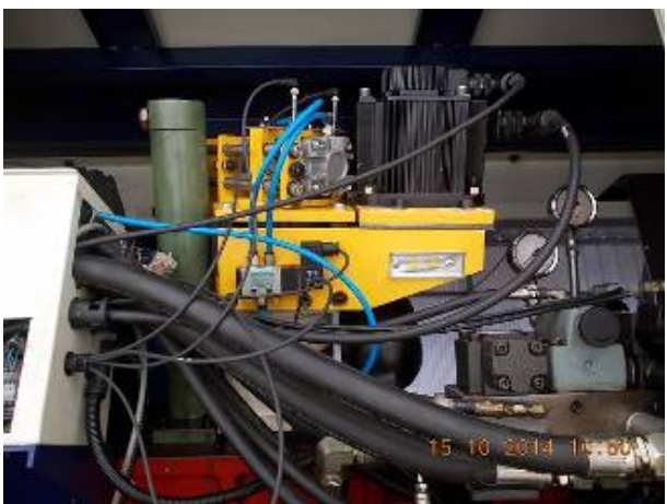
Der ganze Z Antrieb wurde mit einer Unter- setzung 1:2 Konstruktion Wiap erneuert.
