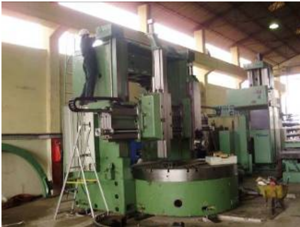
Vormals eine konventionelle Karussell Drehmaschine und jetzt neu eine CNC gesteuerte Maschine. WU_240_210
