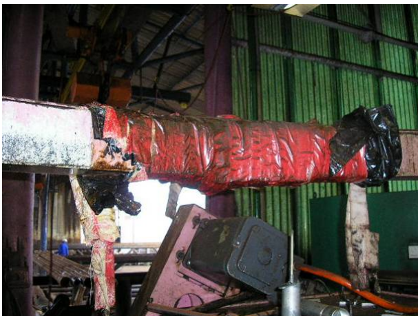
Photo 2: Hier hat man verhindert, dass Wasser in die CNC läuft, trotzdem war die immer nass. Es sieht nach grosser Menge Kondenswasser aus. Die Aircon lief immer auf Hochtouren.
