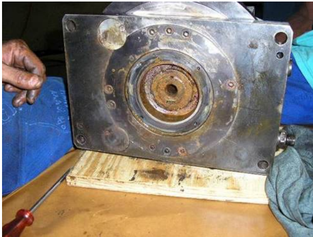
Photo: Beim Abschrauben des Revolvers die ersten Rostvorankündigungen.
