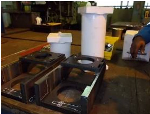
Bild 23: Material, das der neue Motor benötigt. Da wir an allen Maschinen dieselben Motoren haben, müssen wir eine Reduktion 1 : 3 machen. WU_232_170
