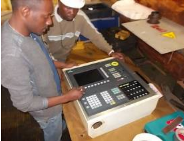
Bild 22: Yoba baut die Sinumerik 802 ein. Das Blech vorne wurde aus rostfreiem Stahl gemacht. Das Gewindeschneiden bei rostfreiem Stahl ist schwieriger als in normalem Baustahl. WU_232_160
