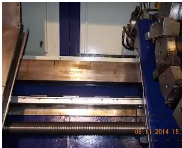
Bild 51: Je mehr Oel kam, je mehr Abrieb des Gleitbelags kam nach draussen, weil es lange trocken lief.
