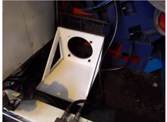
Bild 20: Der neue Motor ist ein Fussmotor. Wir mussten ein Stehloch machen. Aufgrund der Ersatzteilhaltung verwenden wir an allen Maschinen denselben Motortyp. Der ist bei einigen überdimensioniert, doch es gibt dadurch praktisch nie ein Maschinenstillstand aufgrund fehlender Ersatzteile. WU_232_140
