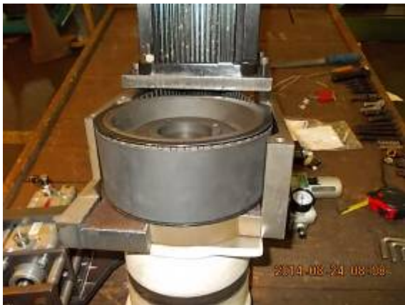
Bild 19: An der Motor Verlängerung haben wir den Motor mit einem Drehflansch gemacht, damit wir den Motor in jede Position drehen können. WU_232_400
