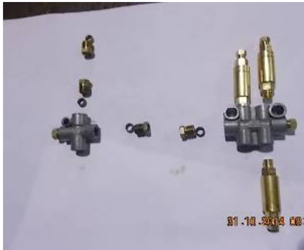
Bild 46: Schmierungsombau. Die Kugelrollspindel bekommt eine Doppelmenge Oel.
