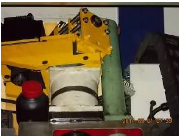
Bild 39: Der X-Motor mit der neuen Bremse. Die Bremse wurde gemacht, damit alles dieselben Vorschubmotoren verwendet werden können.
