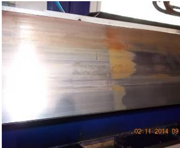
Bild 50: Die Maschine hat eine fehlerhafte Schmierung. Erst als Oel kam, kam der braune Gleitbelag Abrieb zum Vorschein.
