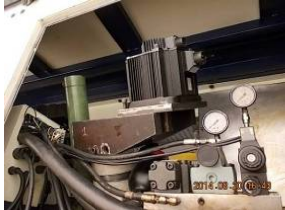
Bild 16: X Motor Anbau. Eine sehr komplizierte Konstruktion, weil wir wenig Platz haben. WU_232_370
