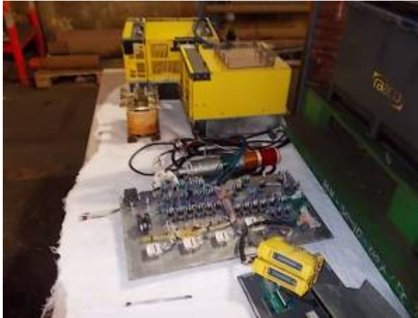
Bild 10: Ausgebautes Steuerungsmaterial der Fanuc 18i. WU_232_100
