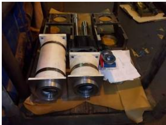
Bild 15: Der Vorschubmotor wurde mit einer Verlängerung und einer Untersetzung hergestellt. WU_232_360
