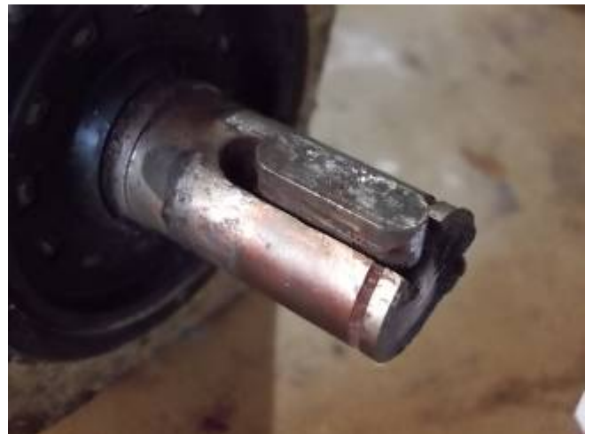
Bild 33: Der Fanuc Spindel Geber hat viel Passrost, weil dieser ohne Achsfluchtfehler Kupplung montiert wurde. Die Welle und das Pully sahen nicht gut aus. Wir haben den Geber mit einen Fluchtfehler Ausgleich eingebaut. WU_232_270
