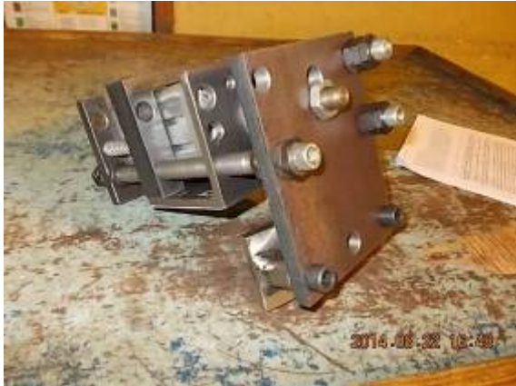
Bild 18: Das ist die Bremskonstruktion. Diese war ursprünglich im Motor. Wir haben jetzt an allen CNC Maschinen denselben Motor, darum wollten wir keinen Motor mit Bremse bestellen. WU_232_390
