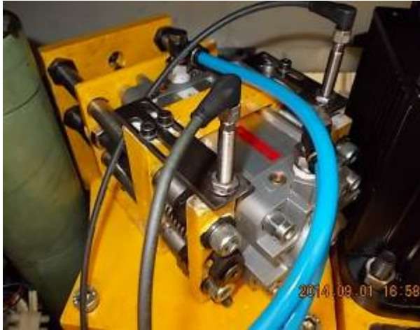
Bild 42: Robuste, eigenentwickelte Bremskonstruktion. Mit Schalter gebremst und ungebremst. So eingestellt, dass auch ein Druck unter 3 Bar erkannt wird.
