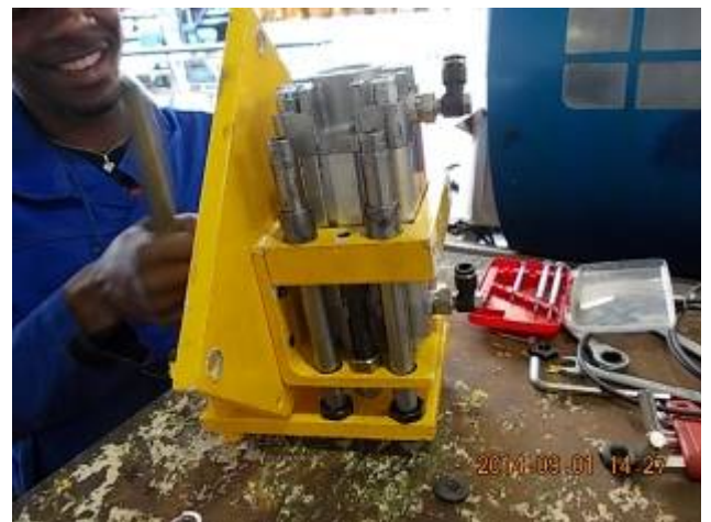
Bild 41: Bremszylinder. Der Zylinder wird als Norm verwendet.
