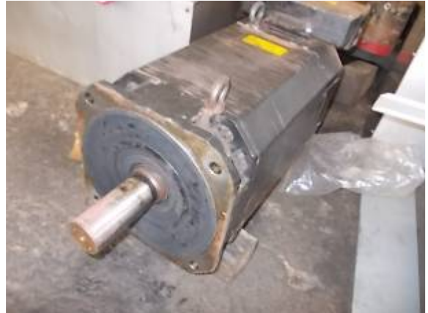
Bild 12: Der Fanuc Hauptspindelmotor sieht hier in Angola nach kurzer Einsatzzeit sehr mitgenommen aus. Das Klima ist hier sehr angriffig, es verfrisst fast alle Produkte. WU_232_120
