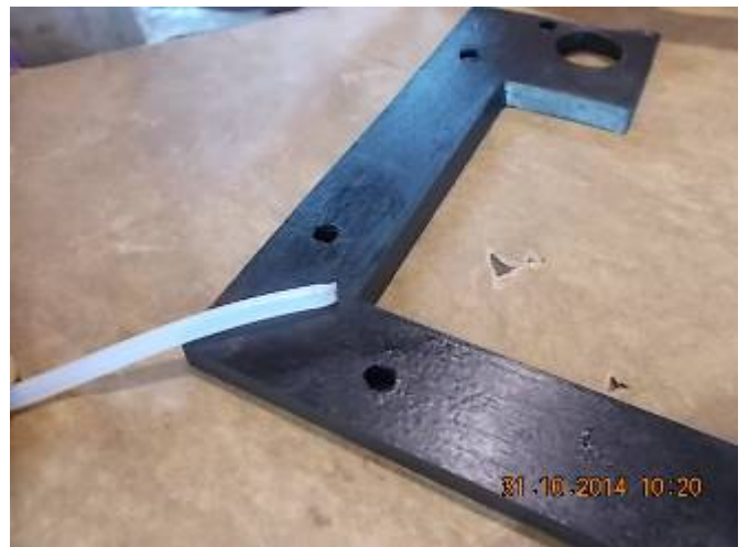
Bild 49: Zusätzliche Schmierstellen für die Z-Achse. Normal macht ein guter Maschinenbauer bei Kurzhub Maschinen mehr Schmierstellen in der Verfahrachse. Mega Bore machte nur eine in der Z Achse. Wenn nun immer Gewinde geschnitten wird mit einem Verfahhub von weniger als 200 mm, wird der lange Schlitten mit nur einer Schmierstelle, ungenügend geschmiert. Wir machten jetzt 3 Schmierstellen pro Führungsbahn. Ideal wären für den langen Schlitten 5 Schmierstellen. Doch dann hätten wir den Schlitten demontieren müssen.
