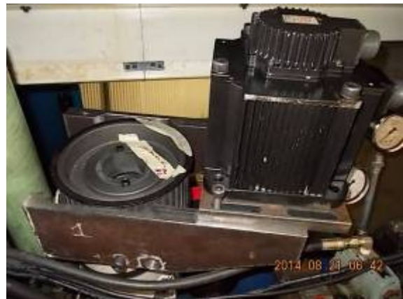
Bild 17: Der X Motor 1/3 untersetzt mit 3 KW. Der alte Motor hatte 7 kW und war 1:1. Jedoch nur 10 M Eilgang mit einer 10-er Kugelrollspindel. WU_232_380
