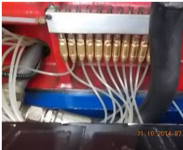
Bild 47: Neue Dossiereinheit für kontrolliertes Schmieren. Die CNC Drehmaschine Mega Bore hat einfach Oel gepumpt, ohne Mengenkontrolle. Die X-Achse bekam zuviel Oel, die Z Achse viel zu wenig. Darum ist jetzt die 2. Kugelrollspindel auch schon wieder defekt. Sie tönt wie ein Traktoren Getriebe.
