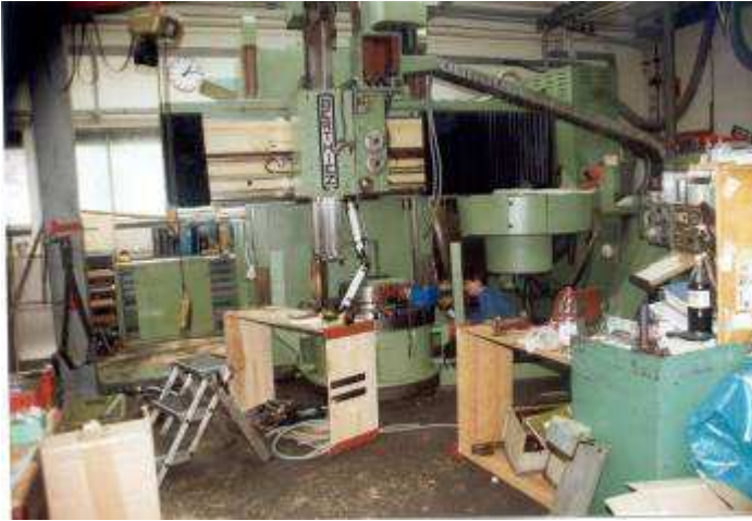
Bild 3: Umbau Berthiez Karussell Drehmaschine durch die WIAP AG.
