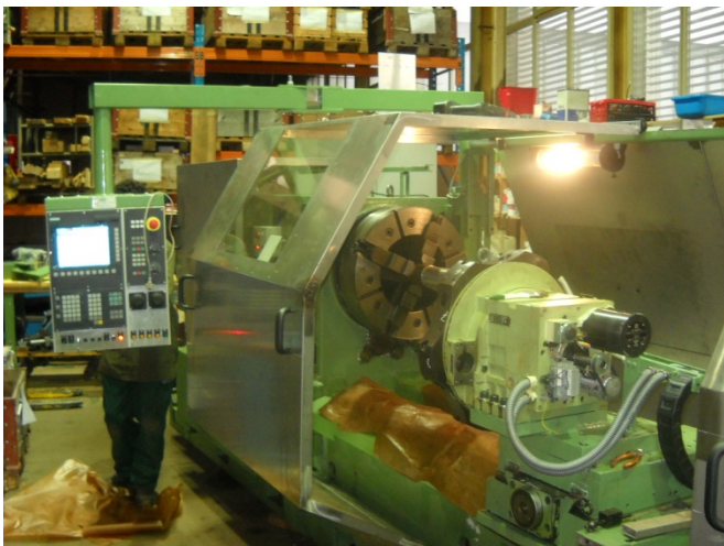
Bild 25: Jetzt ist die Olefeldrehmaschine, welche umgebaut wurde aus einer konventionellen, fertig und kann geliefert werden. Neue Kugelrollspindeln. Neuer Werkzeugrevolver; Bett neu geschliffen; Schlitten neu geschliffen und Neues mit Gleitbelag belegt. Neuestes Schmieresystem; neuer Spindeltrieb und vieles mehr. Eine Stärke der Wiap AG. Aus alt macht neu.
