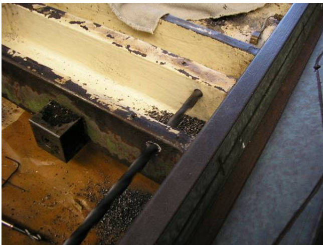
Bild 16: Es wird so gebohrt, dass die Schmierleitungen aus dem Spänebereich montieren werden können. Hier unten gibt es dann eine Abdeckung WU_260_120
