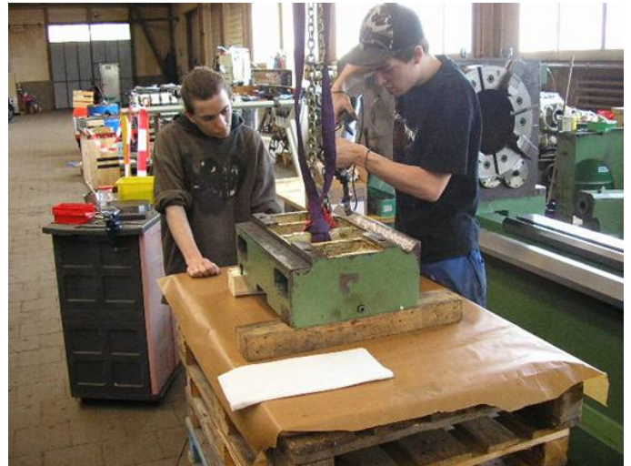
Bild 13: Stundenlang schaben und immer wieder den Schlitten neu auf die geschliffene Auflage legen und abtouchieren. Wenn 10 – 15 Auflage Punkte auf einem Inch im/2 (25,4 mm /2) da ist, ist es ok nach alten Regeln. Für Schleifmaschinen sind 25 Auflage Punkte pro /2 Inch nötig. WU_260_90
