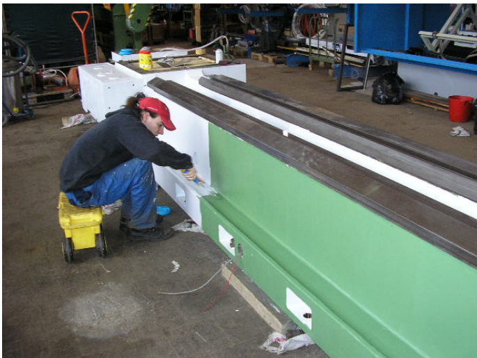
Bild 20: So ein schweres Maschinenbett in eine Malerei bringen ist aufwendig und kompliziert, während einem Maschinen Rückaufbau. Doch es braucht 100 % Disziplin. Sauber reinigen, gute 2 K Farbe, welche Lösungsmittel und emulsionsbeständig ist ab der Grundierfarbe. Und eine gute Qualitätssicherung. Jeder muss den Andern kontrollieren, dass nicht geschlampt wird.
