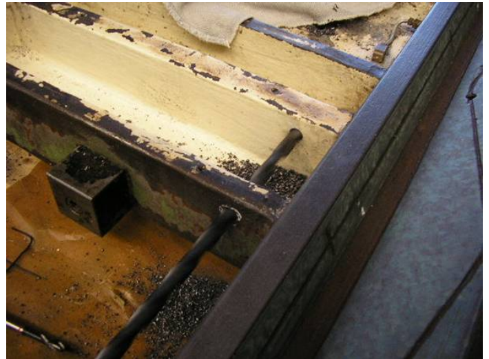
Bild 17: Es benötigt lange Bohrer und oft ist der Guss recht hart, was mit dem Abkühlen und der Wandstärke der jeweiligen Zonen zusammenhängt, da muss mit Fingerspitzengefühl gebohrt werden WU_260_130
