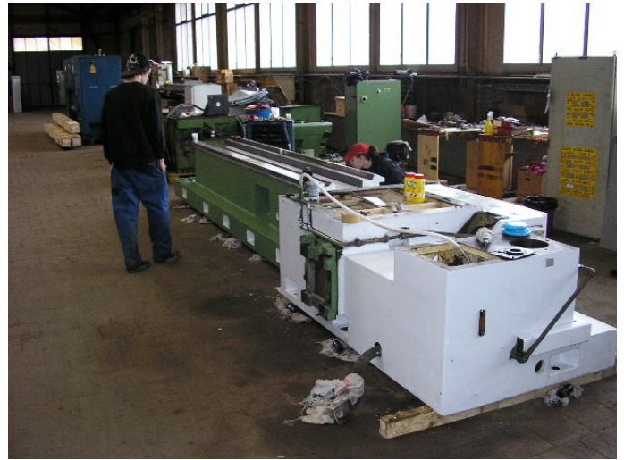
Bild 22: Die Maschine hat schwer gelitten in Angola, nur wenige Meter vom Meer entfernt. Das frisst alles an, darum haben wir die beste Qualitätsfarbe eingekauft und es mit dem Farblieferant vorher noch abgestimmt.
