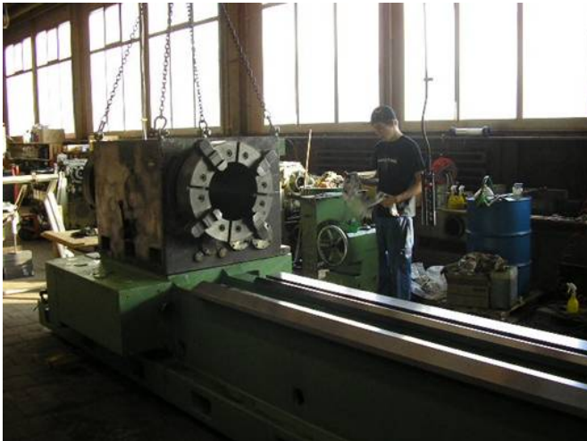
Bild 24: So ein Oelfeldspindelstock ist schwer. Die Flucht zur Z Achse muss einwandfrei stimmen. Ideal auf 300 mm weniger als 0.03mm Konizität das ist im Radius 0.015 und das auf die richtige Seite. In der Regel immer vorne weiter weg vom Futter dünner, weil der Schnittdruck durch das Werkzeug immer weiter vom Futter entfernt, mehr drückt.
