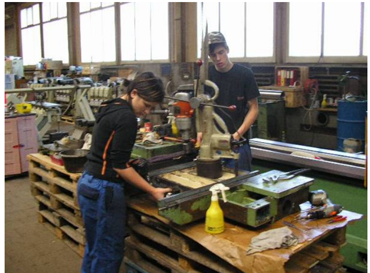
Bild 14: Caroline Widmer bohrt neue Schmierbohrungen in den Schlitten. WU_260_100
