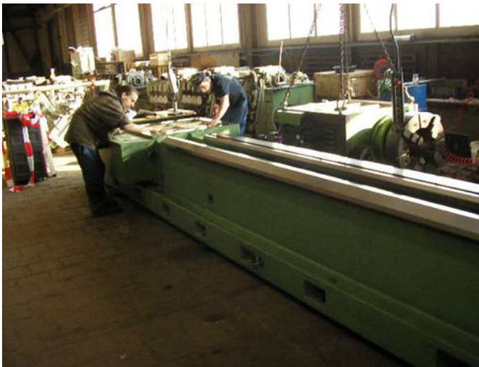
Bild 6: Die Maschine wurde aus Angola in die Schweiz geliefert, um komplett neu zu überholen. Montage Fuji Seiki Maschine für die Ölindustrie mit neuer CNC Steuerung. Ganze Geometrie wird besser, als bei einer neuen Maschine gemacht. Der Guss ist gealtert, das Bett neu geschliffen. WU_260_30
