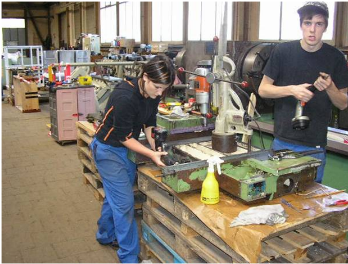
Bild 15: Das benötigt einige Kraft. Es soll jedoch viele neue Schmierbohrungen geben, da die Maschinen Kurzhub Anlagen sind wie diese Oelfeldgewinde, oft nur in ca. 150 bis 200 mm Dauerwegbereich fahren, muss genug geschmiert werden in beiden Achsen X und Z. Wir haben mind. 3 x mehr Schmierstellen gemacht . WU_260_110
