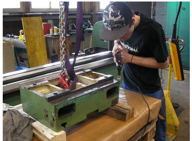
Bild 8: Das Schaben ist eine alte Handarbeit, welche bei Gusslitten gute Gleitfähigkeit ohne Stip Slik ermöglicht. WU_260_50
