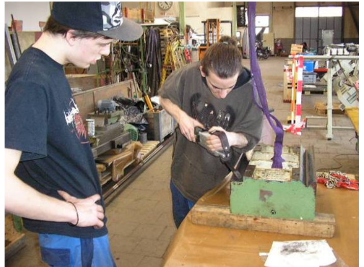
Bild 7: Schaben der Geometrie. Pro Schabdurchgang kann ca. 0,004 mm abgetragen werden. WU_260_40
