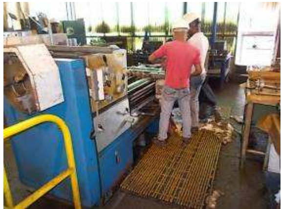
P32) Hier haben wir die Tur Drehmaschine auch zerlegen müssen. Das Gewindeschneiden ging nicht mehr.
