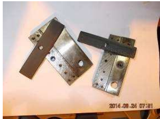
P44) Wieder, aufgrund der V Führung, wird der Untergriff, der noch nicht so alten Maschine TUR, so belastet, dass es die Gleitbeläge durch die Querkräfte und dann das intensive nach oben drücken, abgerissen hat. Wir mussten die Klebefläche neu aufrauen, damit es Hohlräume für den Klebstoff hat. Danach neu Kleben. Mit Messing Senkschrauben gegen das erneute Abreißen der Gleitbeläge geschützt.
