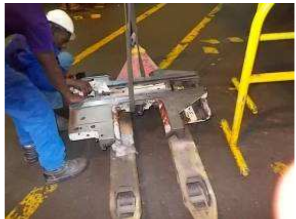
P43) Der Kreuzschlitten wird nach der gründlichen Reinigung wieder für die Montage vorbereitet.
