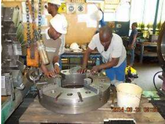
P29) Das Futter wurde demontiert, gereinigt und die Verletzungen abgezogen. Die defekte Spindel provisorisch repariert bis eine neue Spindel da ist.
