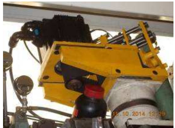
P 15) Der neu angebaute X Spindel Vorschubantrieb.
