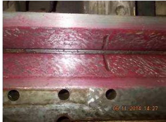
P53) Als der Schlitten weg war, haben wir gesehen, dass die Laufflächen der Führungen so stark abgenützt waren, dass keine Schmierfächer mehr vorhanden waren. Wir schabten die Schlittenlaufflächen noch nach. Da ungeschabte Laufflächen stark zu Stik Slip neigen, was auch die Schwergängigkeit für den Operateur beeinflusst.
