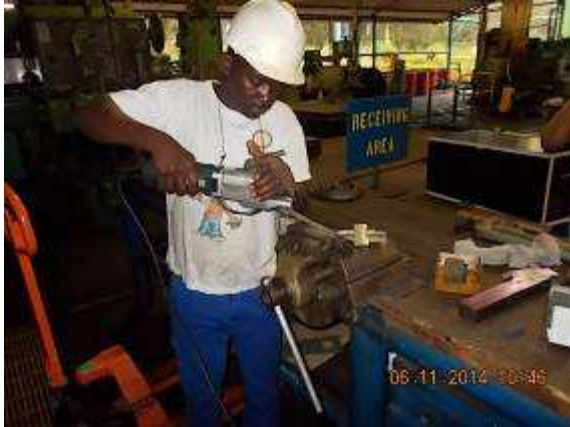
P54) Da diese Arbeit sehr heikel ist, mussten die Unterhaltsleute zuerst ein Test an einem Teststück machen, mit der elektrischen Biax Schabmaschine. Alberto beim Schaben.
