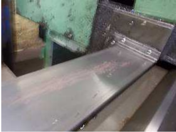
P74) Nur wenige Tage Maschinenstillstand und schon ist der Rost da.
