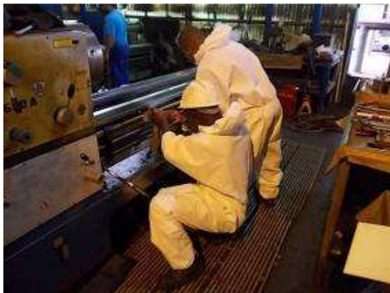
P41) UVEC Schutzanzüge sind in Angola Pflicht. Ohne diese darf nicht mit Diesel gereinigt werden.
