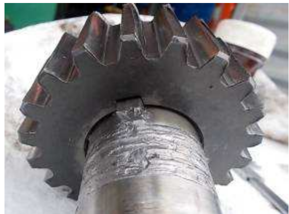
P70) Das grosse Zahnrad: Auf der Welle hat es die Keile abgeschert.
