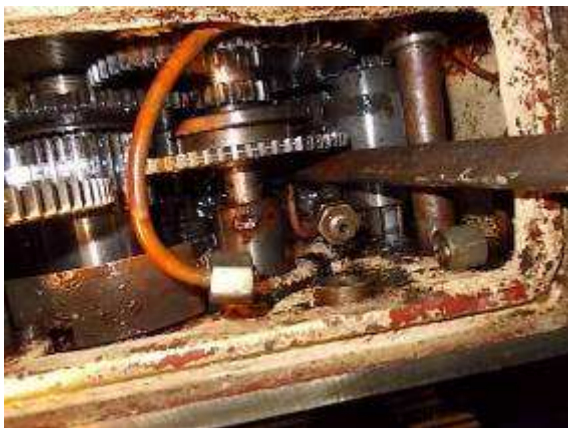
P40) Das Getriebe hatte viel Schlamm und Schmutz unten drin. Es ist unmöglich, dies ohne Demontage, je einmal reinigen zu können.
