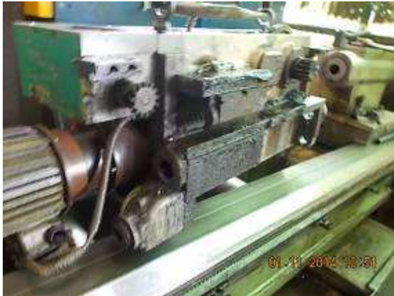
P49) An der Niles Drehmaschine hat es jetzt 3 mal einen Stift abgerissen. Einmal den Axiallagerbock abgedrückt und zerrissen.
