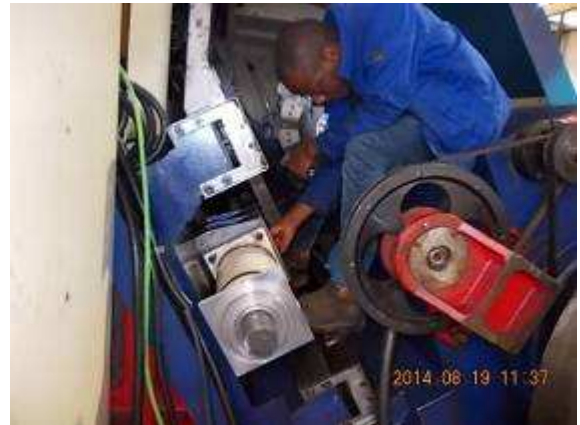
P10) Yoba bei der Montage der Z-Motor Verlängerung.
