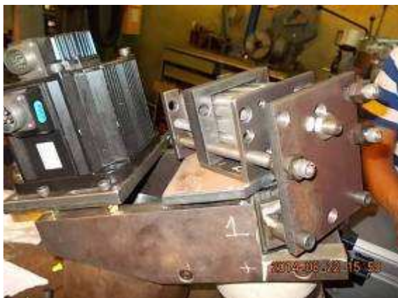
P8) Das ist jetzt die Riemen Bremse mit dem 63-Zylinder. Er drückt mit 6 Bar, 164 kg.
