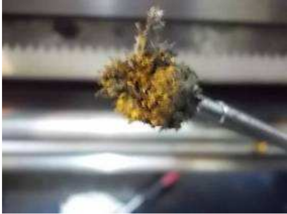
P34) Viele solche Magnete voll Späne waren in der Schlossmutter. Darum hängte sie nicht mehr richtig ein und hat auch die Gewinde verschnitten. Wir entschieden dann, die Spindel umzudrehen. Wir müssen sehen, ob die noch nachbestellt werden kann, weil die Polen Firmen einiges reorganisiert haben. Diese Maschine wurde 1990 gekauft, also direkt nach der Wende.
