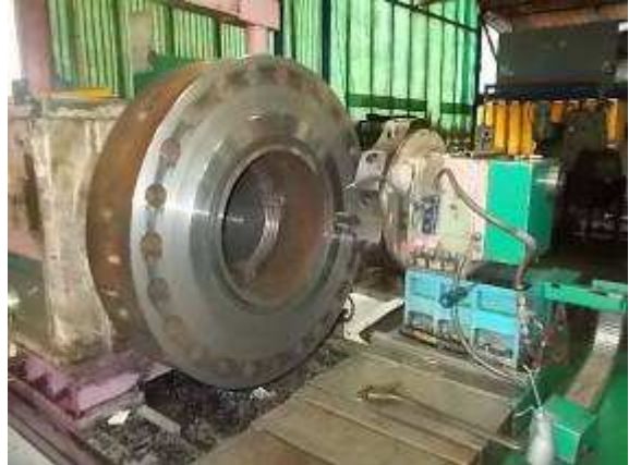
P31a) Kaum ist das Futter repariert, kommen wieder alle Werkstückgrößen auf diese Maschine. Oft arbeitet die Maschine Tag und Nacht.
