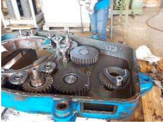
P70a: Gereinigtes Getriebe nach der Ersatzteilaufnahme
