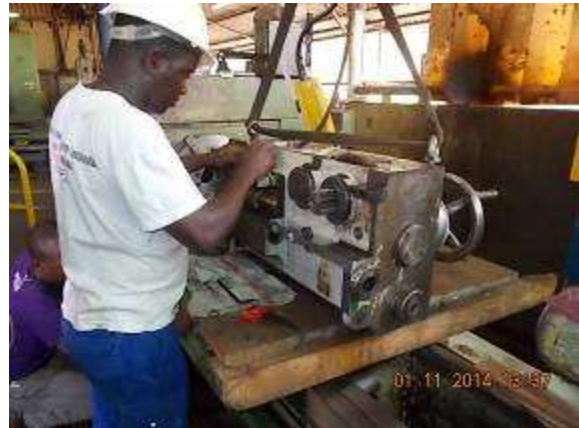
P52) Das Vorschubgetriebe vom Kreuzschlitten wurde zerlegt und die Klemmstelle ausfindig gemacht. Ein Teil der Mutter, die über die Trapezspindel ist, ist nicht aus dem Gewinde heraus gegangen und hat dann die Verstiftung weggerissen.
