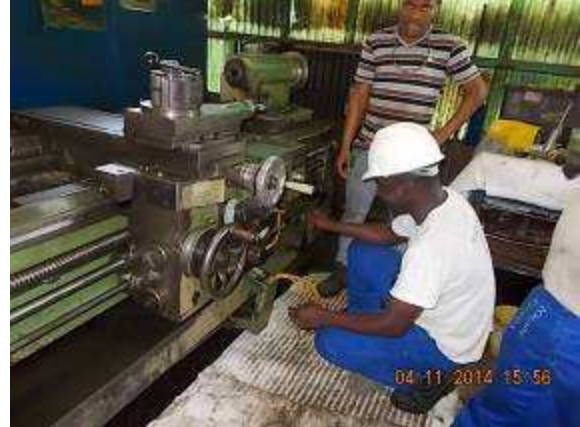
P57) Nach ca. 4 Arbeitstagen war der Schlitten wieder montiert.
