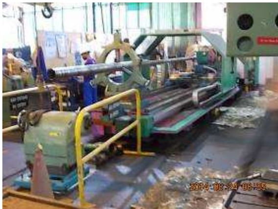
P31) Die Welle guckt sicher 2 Meter über die Maschine hinaus. Der Reitstock musste weggenommen werden.
