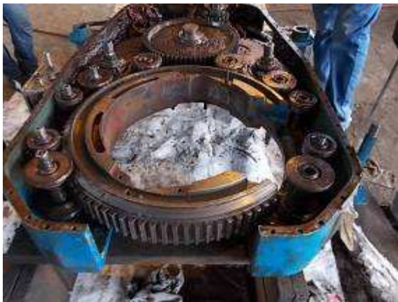
P66) Das Getriebe sieht innen sehr schmutzig aus.
