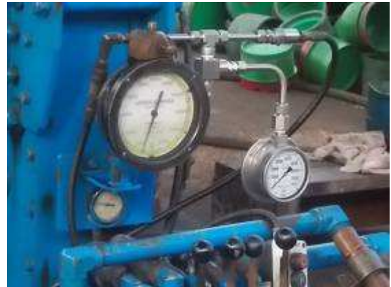
P72) Eine erweiterte Manometer Lösung erleichtert das Arbeiten an der Maschine.
