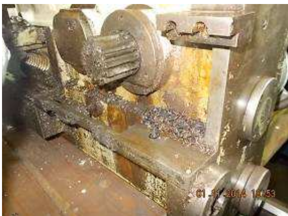
P51) Es wurde der Kreuzschlitten demontiert um den Fehler zu sehen.
