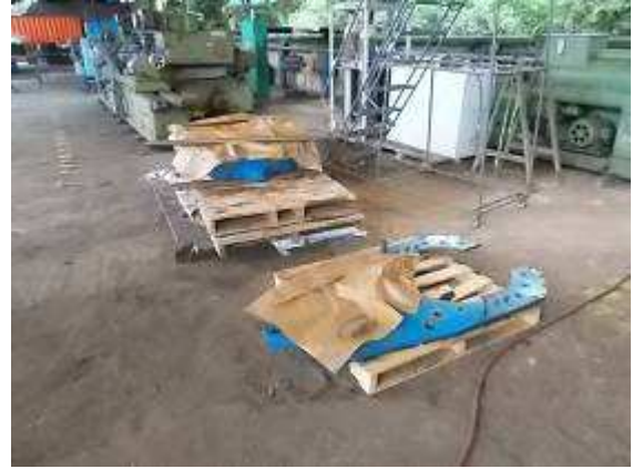
P71b) Bis die Ersatzteile in Angola sind, muss die demonitierte Ware gut geschützt werden. Einölen / fetten und zudecken mit Oelpapier .
