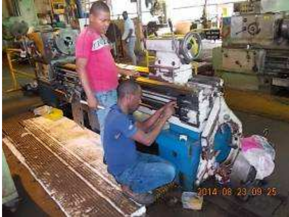
P45) Die Wiedermontage im Prozess. Yoba und Bambi. Kevin bringt neue Riemen und ein neues Axiallager aus der Schweiz mit .
