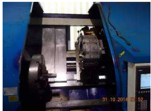
P16) Die Mega Bore CNC Drehmaschine. Neu mit der Sinumerik 802Dsl CNC Steuerung.
