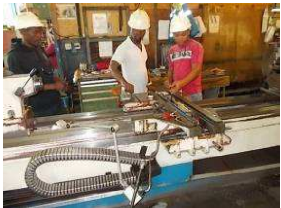
P33) Den ganzen Schlitten mussten wir herunter nehmen, weil die Schmierpumpe nicht mehr ging und wir die Ursache wissen wollten.
