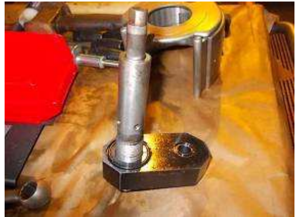
P37) Das ist die Schmierpumpe, welche nicht mehr schmierte. Mit einem Excenter wird diese angetrieben, wenn im Eilgang in der Z-Achse gefahren wird.
