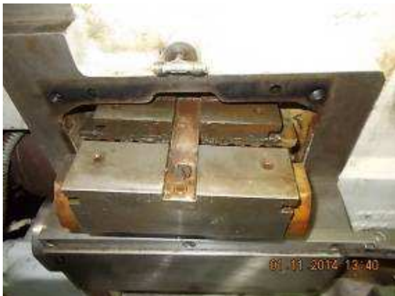
P56) Diese geteilte Mutter klemmte und ging nicht in die Selbstzentrierung. Sie blieb gelegentlich in der Trapezspindel hängen und blockierte.
