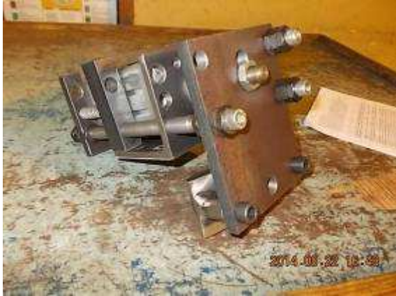
P6) Das ist die Bremskonstruktion. Diese war am alten Motor im Motor. Wir haben jetzt an allen CNC Maschinen denselben Motor. Daher wollten wir keinen Motor mit Bremse bestellen.
