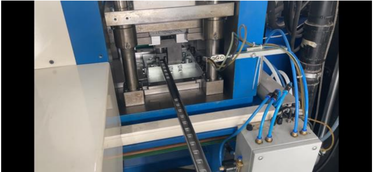
Bild 7: Hier das Fertigteil das hinten gestanzt aus der Maschine kommt. Im zehntel mm Bereich wird gestanzt
