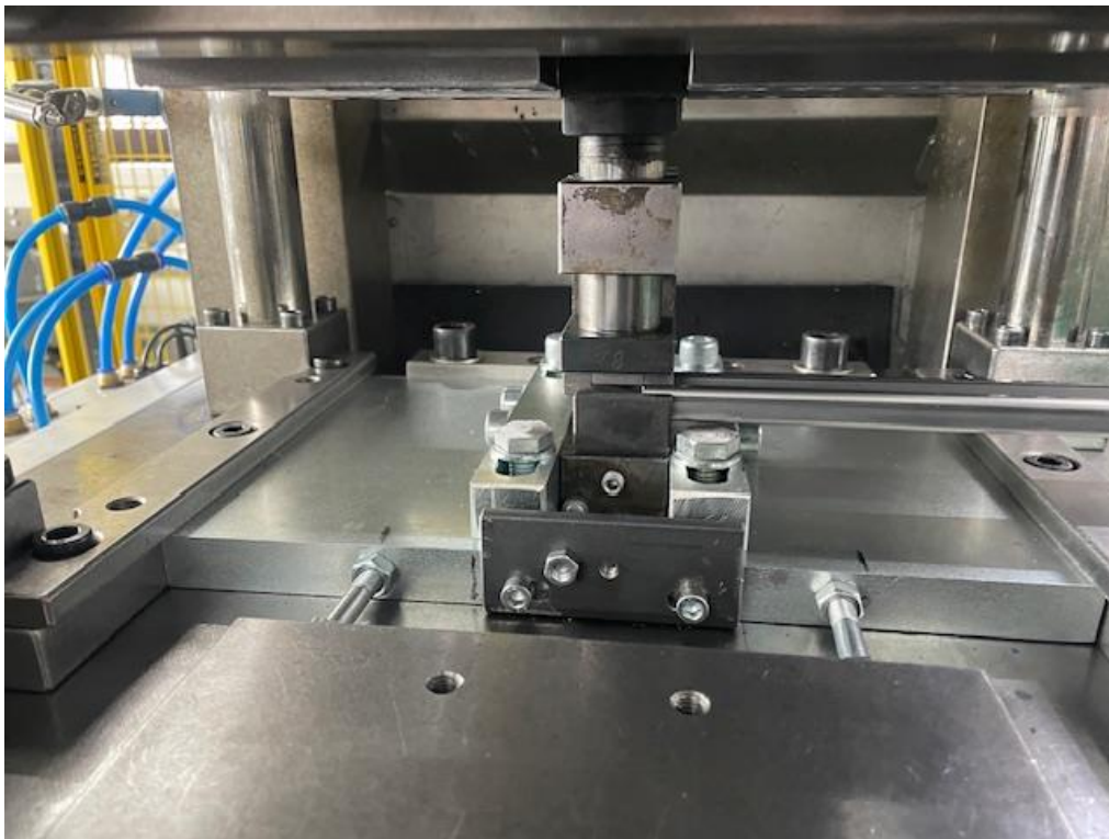
Bild 4 Ansicht der neuen von Wiap konstruierten und hergestellten Grundplatte wo die alte Stanzeinheit drauf montiert wurde.
