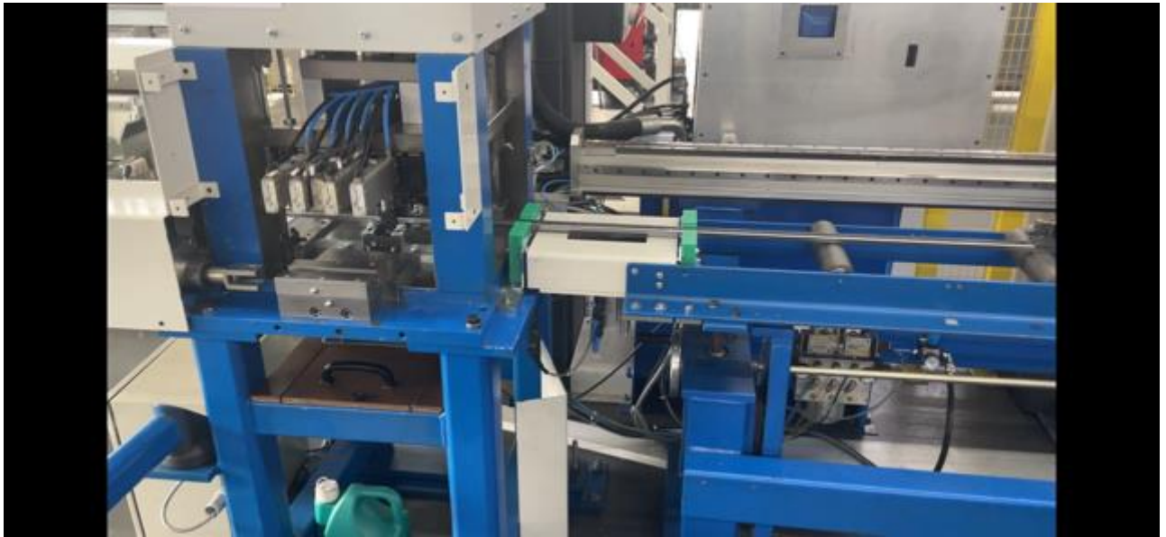
Bild 3 CNC Edel Stanze. Vorne mit zusätzlichen Seiten Stempeln genannt als T1 bis T5
