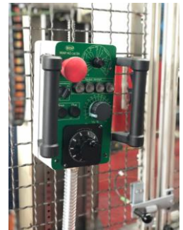
Bild 6.5.A links vorher Bild 6.5B rechts nachher. Das neue externe Steuerpanel kann alle 8 Achsen fahren mit Handrad und Inkrementen.
