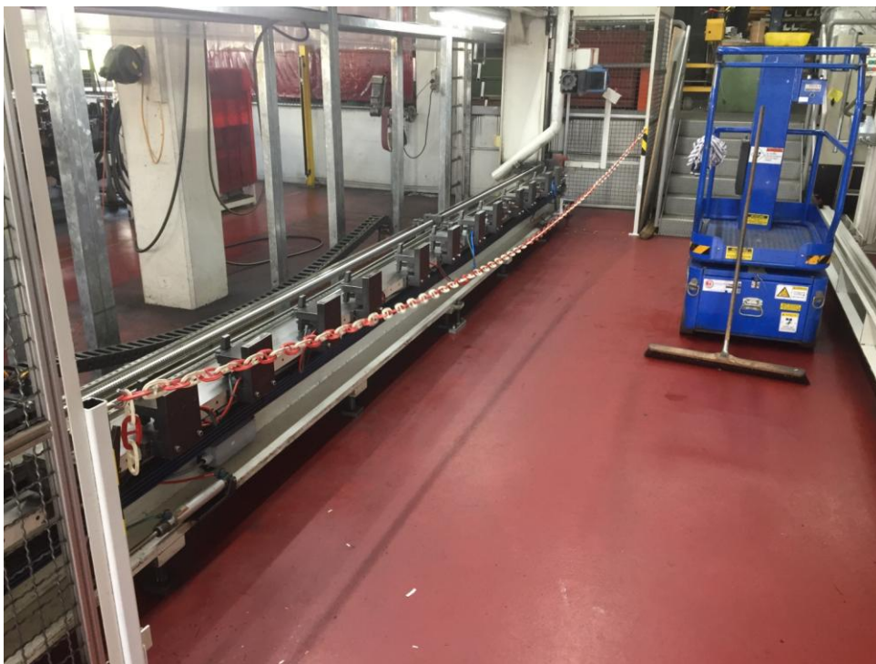
Bild 4.2: Wenn die Maschine ohne Operateur, also mannarm arbeitet, ist der Operateur angehalten, immer die Schutzkette zu schliessen, damit keine Personengefährdung erfolgen kann. Nebst Horn und Stoppzone über Lichtschranken ist das eine zusätzliche Sicherheit vor allem, wenn Betriebsführungen stattfinden.
