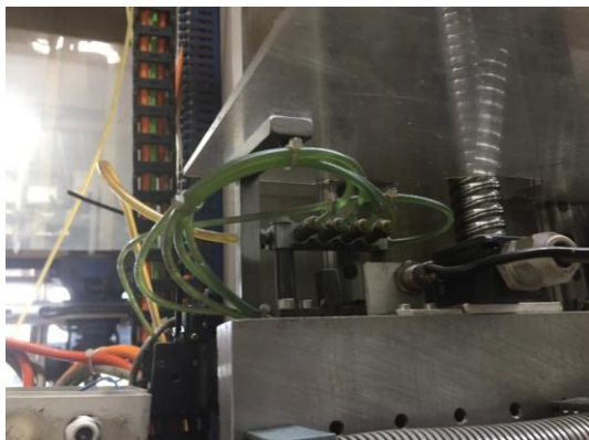
Bild 6.3: Seiten Schlitten links und rechts Schmierung von oben
