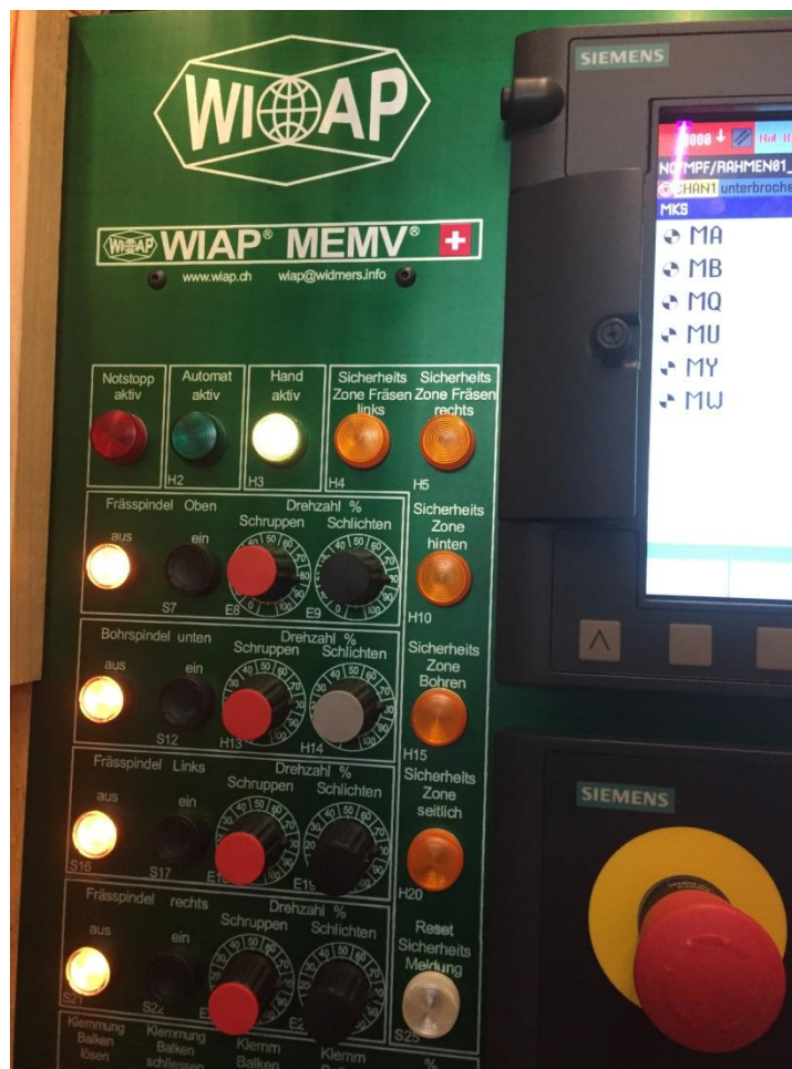
Bild 4.1: An dem Bedienpanel der CNC Steuerung sind alle Schutzzonen mit Leuchten versehen, so dass, wenn Personen Zonen betreten und die Anlage in einen Stopp geht, sofort erkannt wird, welche Zone den Alarm auslöste. Nur mit Löschen des Alarms kann die Anlage wieder gestartet werden.
