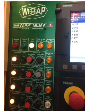
Bild 6.8. Einzel Potentiometer für die Einstellung aller Drehzahlen der Fräs- und Bohrspindeln. Schrupp- und Schlichtgeschwindigkeit, programmierbar über die CNC
