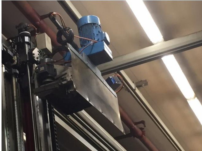
Bild 6.10. Alle Bohr und Fräseinheiten sind Suhner Einheiten. Oben Fräsen Uebersetzung 1/1,5 poliger Motor macht 1400 Umdrehungen Spindel unten ----- mit FU 80% = 50 Hz. Kann auf 60 Hz erhöht werden mit dem % Schalter am Panel
