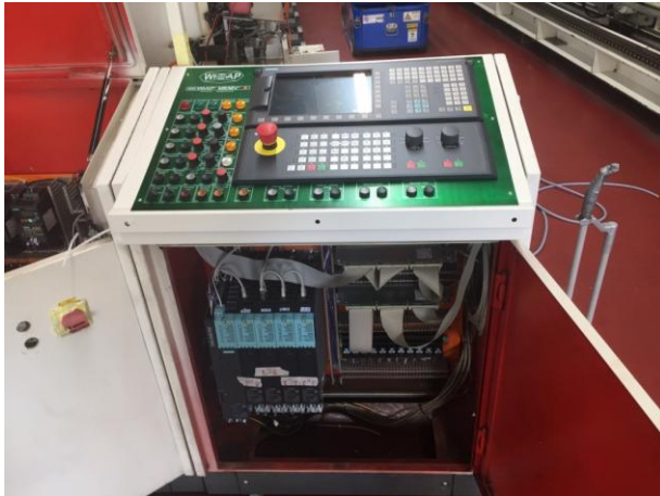
Bild 6.6. Unter dem Steuerschrank sind die 4 Achsmodule angeordnet, welche jeweils ein Achsenpaar der 4 Gruppen ansteuert.
