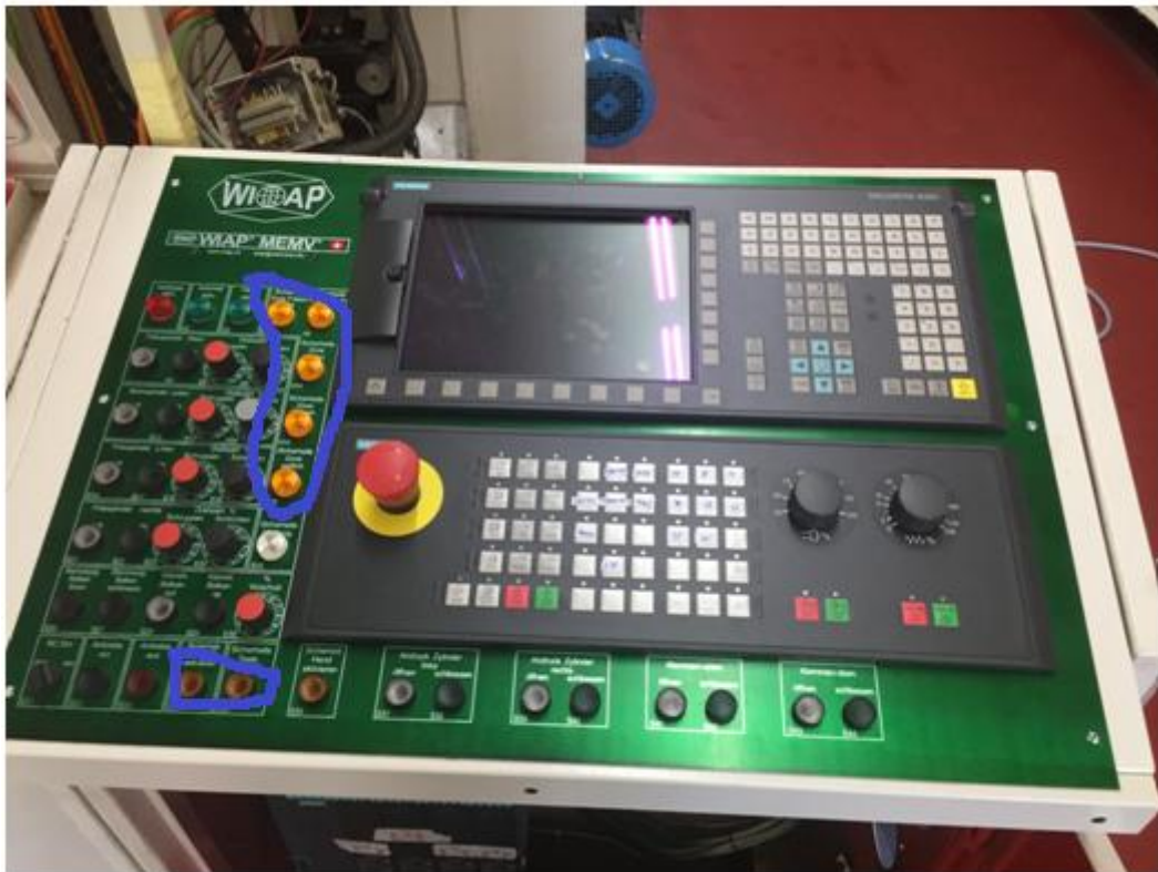
Bild 4.2 : Oben (blau markiert) die Anzeige , wenn eine der 4 Schutzzonen betreten wurde. Unten (blau markiert) Schutzzonen löschen / rücksetzen
