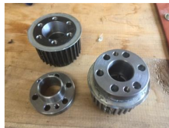
Bild 2.4-5 Wiap Pully System 7° Anzug, 3mm Fleisch, 10/11mm Tiefe
