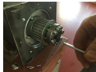
Bild 2.4-6 Pully Klemmsystem ähnlich Taper Lock, jedoch für engere Platzverhältnisse
